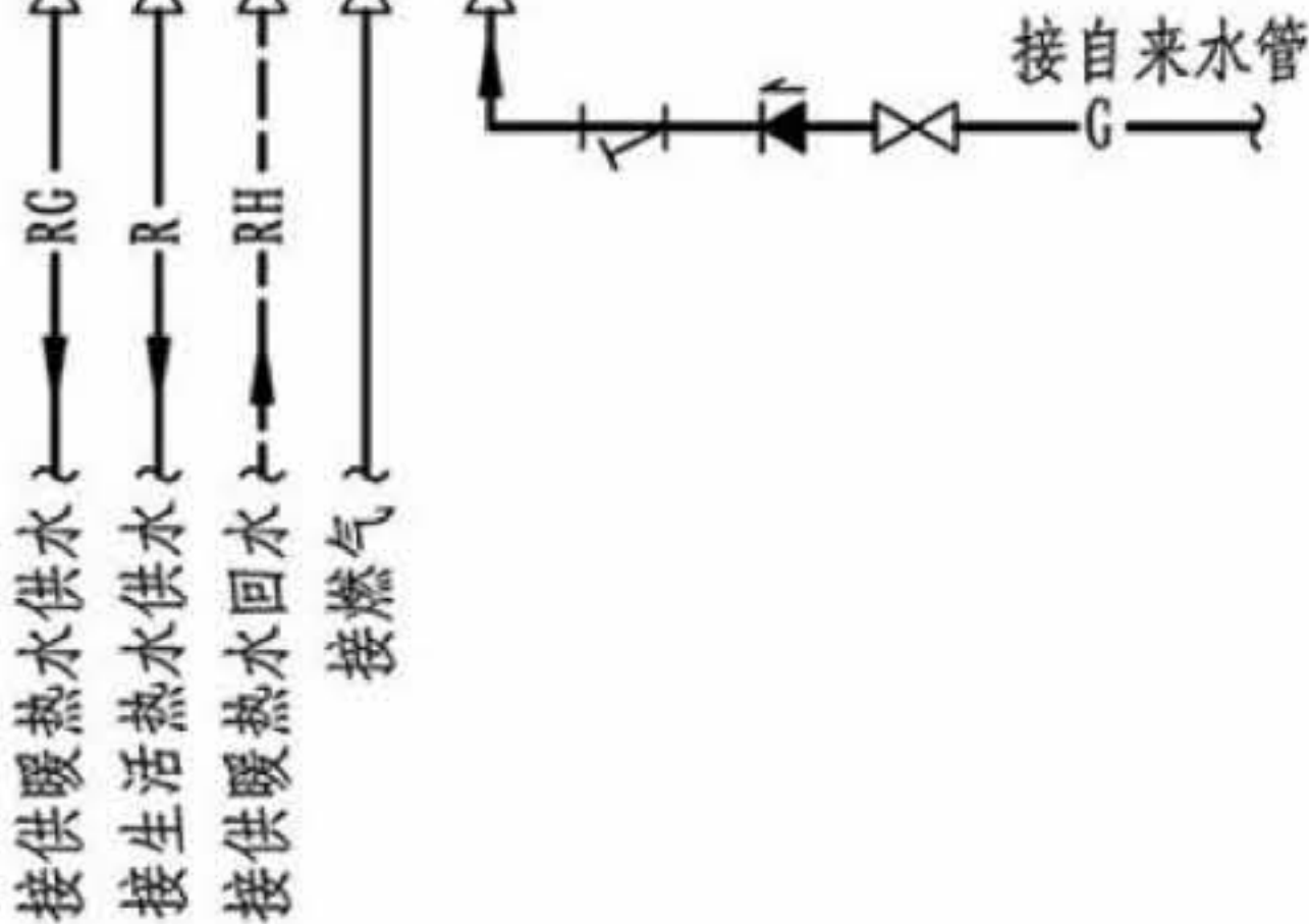
户式燃气壁挂炉接管原理图
