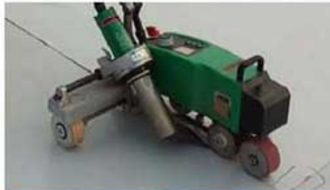
PVC机械焊接施工
