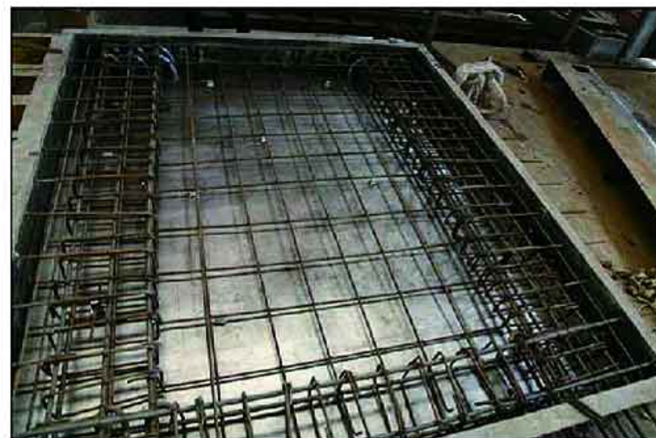
预制墙板内置钢筋局部（二）
