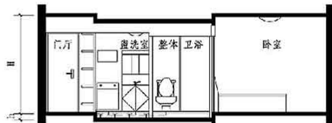
图10 SI住宅体系排水方式示意图(降板)
