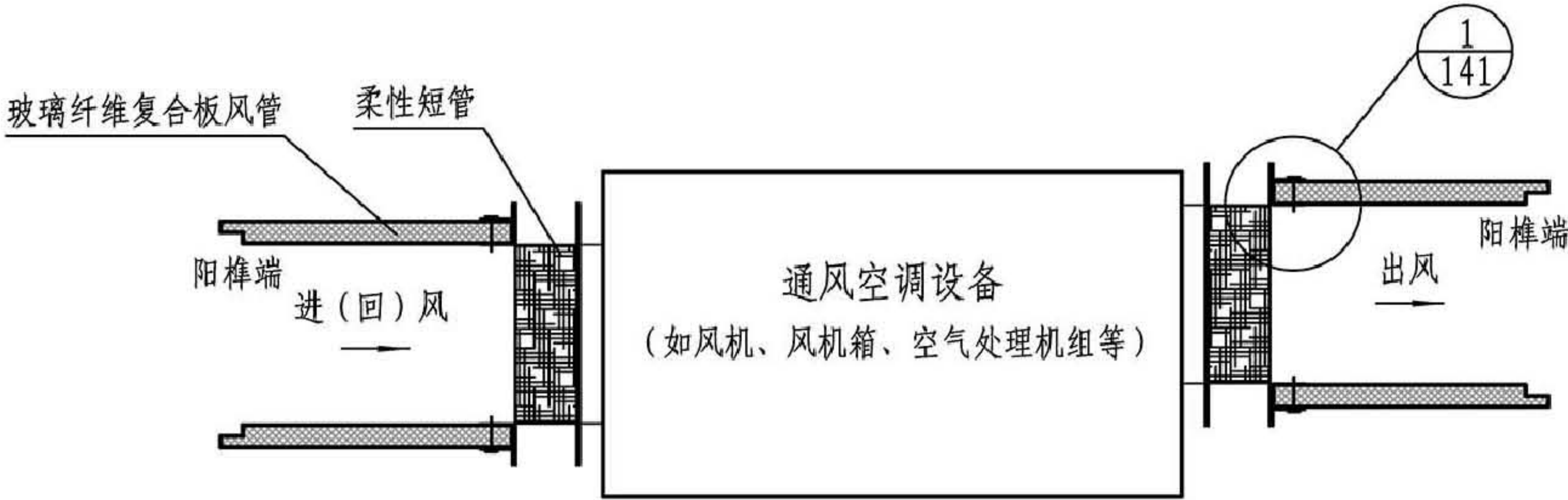
风管的连接方向示意图
