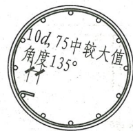
螺旋箍筋端部构造
