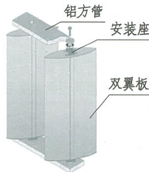
双翼板可调式系统组成示意图
