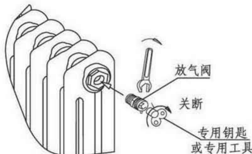
钢管散热器的放气阀及其安装
