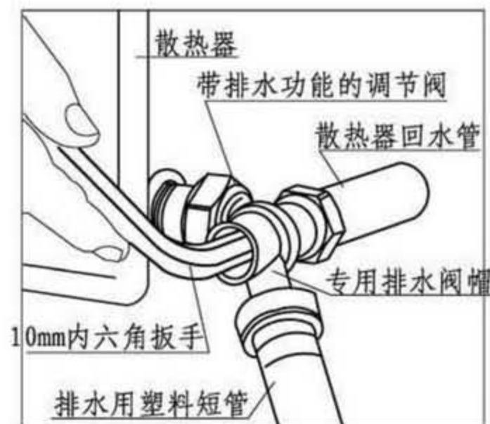
转角型锁闭排水阀的安装
