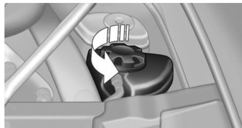
3. 如果冷却液液位在加液口的最小和最大标记之间，则说明冷却液液位正确。
