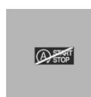
该显示表示没有满足自动关闭发动机的前提条件。
