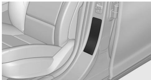
在驾驶员侧车门门柱上可以看到许用轮胎规格的压力数据。
