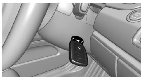
**自动变速箱：**当出现相应的检查控制信息时，如图所示，将遥控器保持在转向柱上的标记上，并且踩下刹车在 10 秒钟之内按下启动/关闭按钮。
