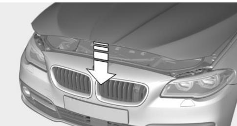
使发动机室罩从约 40 厘米的高度自由落下，然后按压以使发动机室罩重新完全上锁。
