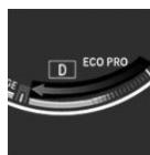
直至条状指示表零点的长箭头在转速表中表示已识别出前方路段。
