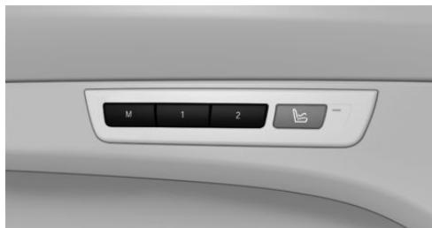
在每个遥控器中可以存储并调出两个不同的驾驶员座椅位置、外后视镜位置和方向盘位置。腰部支撑的调整将不被存储。
