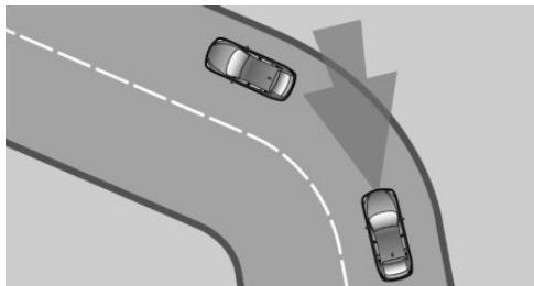
如果在弯道内设置的所需车速过高，系统会自动慢慢降低车速，但是系统无法预先识别出变道。因此请以适当的速度驶入弯道。
