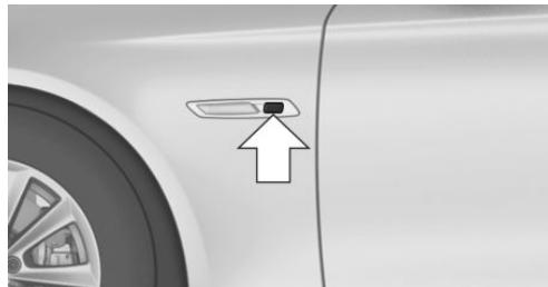
用于测量泊车间隙的超声波传感器位于侧面遮光板之中。
