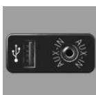
在中间扶手中可以通过外接音频接口或者 USB 音频接口连接一个外部音频设备，例如 MP3 播放器。
