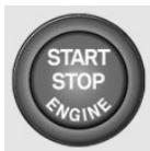
按下起动/停止按钮即可接通或关闭点火系统以及起动发动机。
