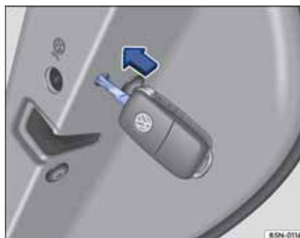
图 200 车门应急上锁装置及汽车钥匙
