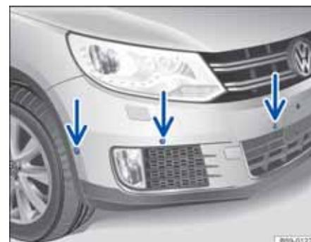
图 145 右前保险杠上智能泊车辅助系统的传感器和驻车距离报警系统的传感器
