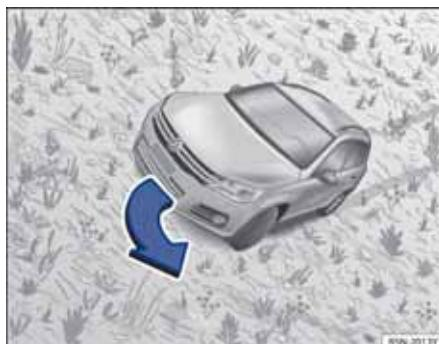
图 182 沿最大坡度向下打方向盘
