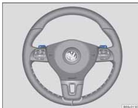
图 120 方向盘上的换挡拨片
