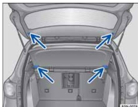
图 86 拆卸和安装行李厢盖板
