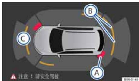
图 129 前后可视驻车系统屏幕显示：① 在碰撞范围内识别到障碍物。② 在扇段区域内识别到障碍物。③ 汽车前方的探测区域。
