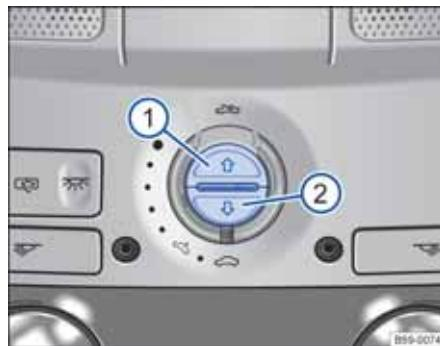
图 32 车顶局部视图：遮阳卷帘按钮
