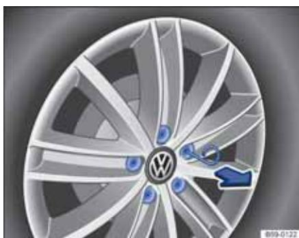
图 207 从车轮螺栓上拔下盖罩
