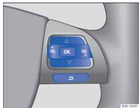
图 12 多功能方向盘右侧：用于操作信息显示器中菜单的按钮。
