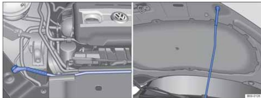
图 185 发动机舱盖支撑杆处于安放及固定位置
