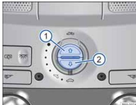
图 30 车顶局部视图：遮阳卷帘按钮
