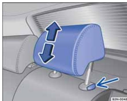
图 46 后排头枕拆卸和安装
