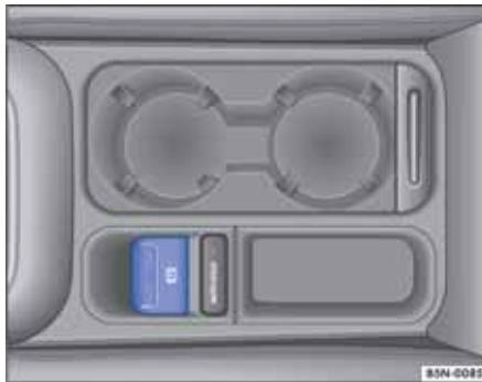
图 122 在中控台下部：电子驻车制动器按钮
