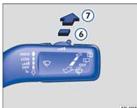
图 79 风窗玻璃刮水器操纵杆示意图：用于后窗
