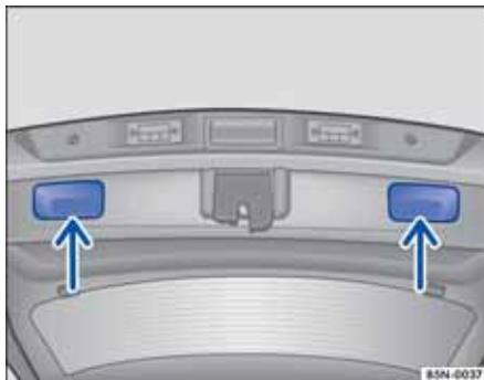
图 26 行李厢盖：用来拉动箱盖的凹槽。
