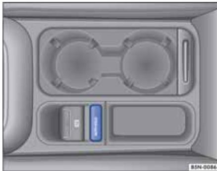
图 126 在中控台中：自动驻车功能按钮
