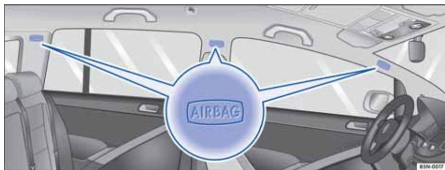
图 66 车内左侧头部安全气囊安装位置
