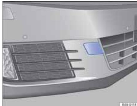
图 214 在保险杠的右前部：拆卸盖板
