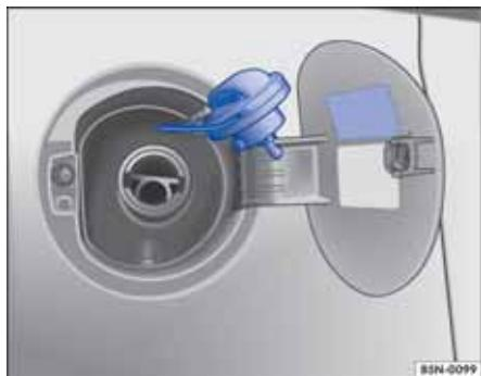
图 175 拧下的加油口盖可挂在打开的燃油箱盖板上
