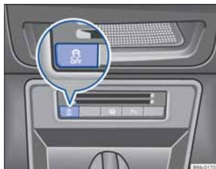
图 123 副仪表板局部图：ASR OFF 按钮开关
