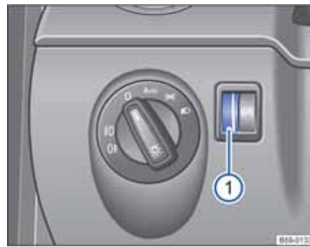
图 73 在方向盘旁边：仪表和开关照明的调节器 ①
