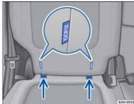
图 68 安装在后排外侧座椅地板上的 ISOFIX 儿童座椅固定环
