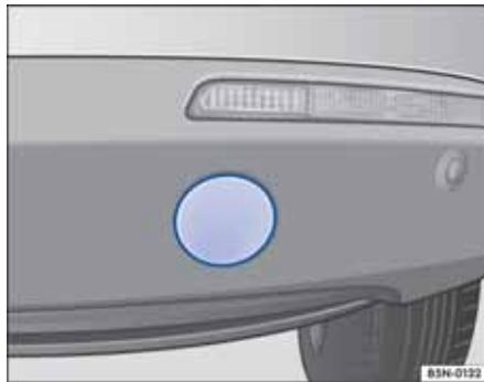
图 216 在保险杠右后部：拆卸盖板
