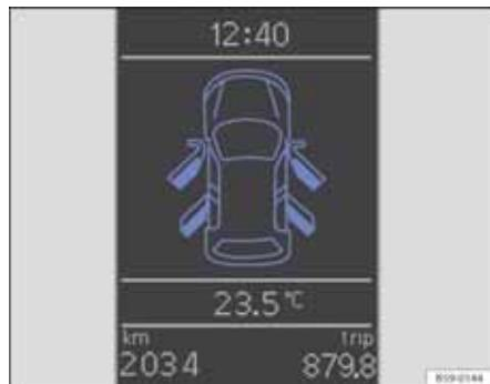
图 21 车门开着时的显示屏显示
