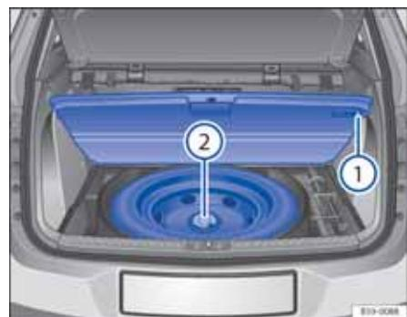
图 206 向上翻起的行李厢底板下的应急车轮
