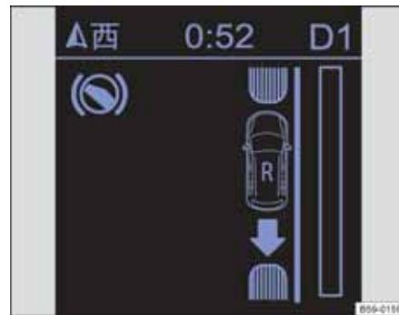
图 147 组合仪表显示：提示挂入倒档
