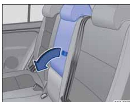
图 100 后座椅靠背内：将中央扶手向前翻折
