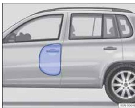
图 65 汽车左侧胀开的侧面安全气囊
