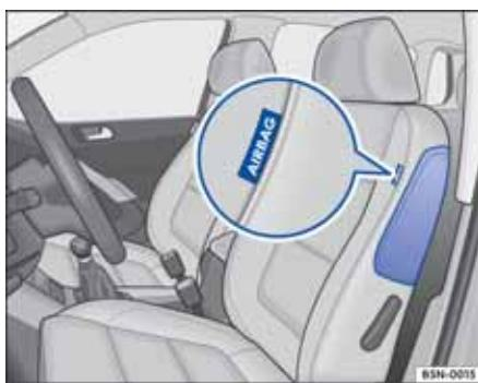
图 64 前座椅上侧面：侧面安全气囊的安装位置。
