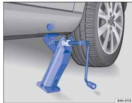
图 210 将千斤顶放在汽车左后侧
