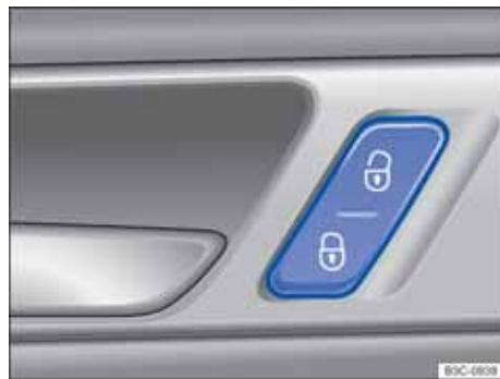
图 18 驾驶员侧车门内：中央门锁按钮。
