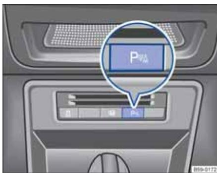
图 127 在中控台中：用于接通或关闭前后驻车距离报警系统的按钮
