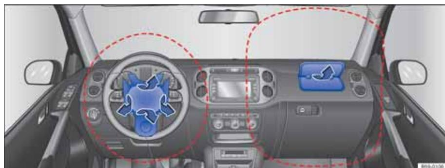
图 63 前排正面安全气囊的安装位置和膨胀范围。
