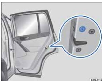
图 199 右侧后车门端面处的应急上锁装置（由橡胶密封件遮盖着）
