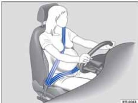
图 60 正确的孕妇安全带佩戴走向。
