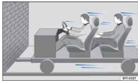
图 52 汽车驶向一砖墙，驾乘人员未系安全带
