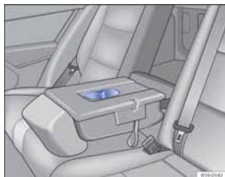
图 103 后排中央扶手上的饮料杯支架
