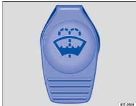
图 80 发动机舱内：风窗清洗液容器盖。
