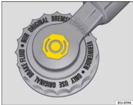
图 124 发动机舱内：制动液容器的盖子。
