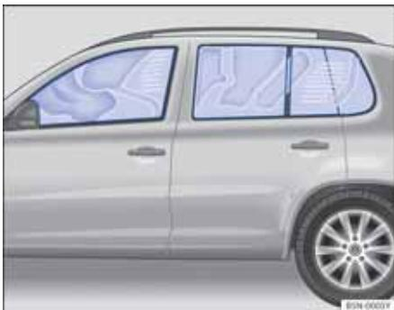
图 67 示意图：膨胀的头部安全气囊
