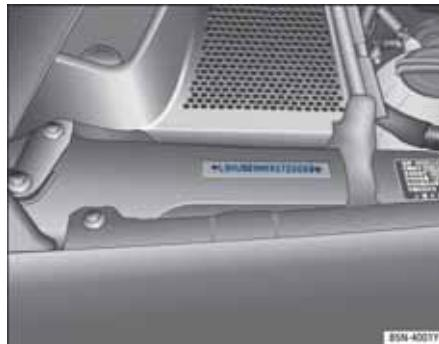
图 14 发动机舱内的底盘号钢印位置
