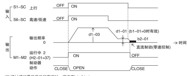
(注)通过模拟量信号进行变速时，请设定b1-01=1。
