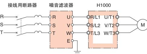
(注)请不要将输入侧噪音滤波器连接在变频器的输出侧(U、V、W)。使用2个以上时请并联连接。Schaffner EMC(株)制造的1个噪音滤波器即可满足各种容量的变频器,因此无需并联连接。
