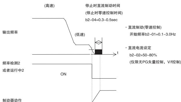
(注)变频器和电机有接触器时，在制动器完全关闭并且变频器基极封锁后动作分离。
