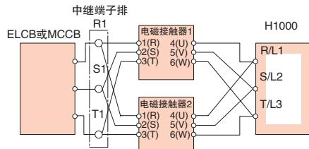
(注)并联连接电磁接触器时,请在中途设置中继端子,且接线长度相同,以获得电流的平衡。
