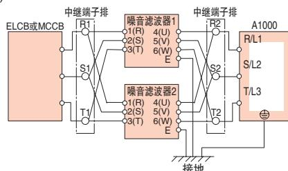
(注)并联连接噪音滤波器时,请在中途设置中继端子排,且接线长度相同,以获得电流的平衡。噪音滤波器、变频器的接地线请尽量增粗或缩短。
