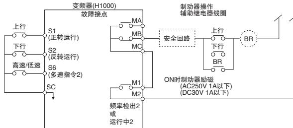
(注)如果顺控侧运行条件成立，请将顺控设定为M1-M2闭(ON)时打开制动机。
