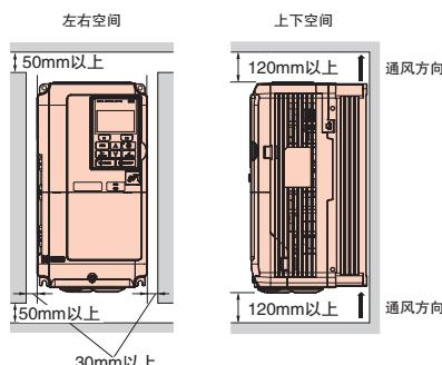
\*: 封闭壁挂型(CIMR-HB4A0039、CIMR-AB4A0044以下)请拆下上部护罩。
