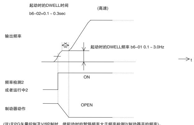
(注)无PG矢量控制及V/f控制时，使起动时的暂停频率大于频率检测2(制动机开的频率)。
