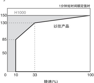
▲ 使用高性能电流矢量控制，感应电机也能实现高起动转矩
