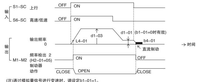
(注)通过模拟量信号进行变速时，请设定b1-01=1。
