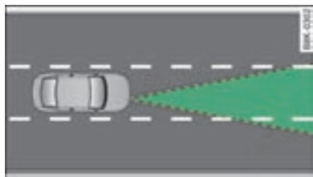
图 123 雷达测距传感器的探测范围
