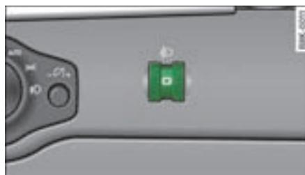
图 44 仪表板：照明距离调节装置调节轮 \*
