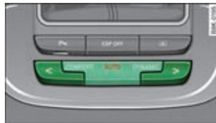
图 160 换档滑槽：奥迪驾驶模式选择系统操作元件
