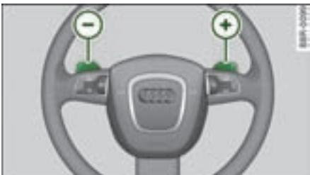
图 168 方向盘：手动电控换档程序开关
