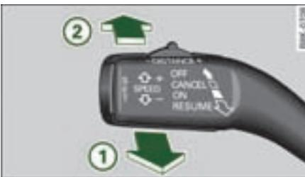
图 127 操纵杆：带记忆功能地关闭和重新打开调节
