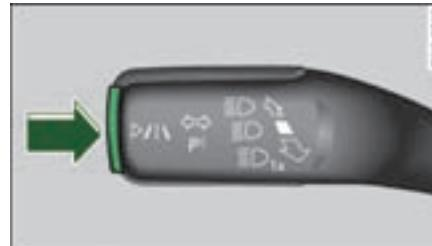
图 144 转向信号灯操纵杆：用于 lane assist 车道保持辅助系统的按钮
