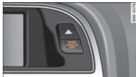
图 216 驾驶员舱：副驾驶员安全气囊已关闭警告灯
