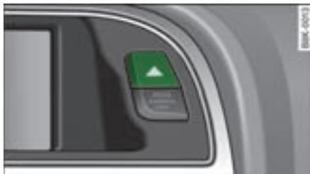
图 49 驾驶员舱：用于闪烁报警装置的开关
