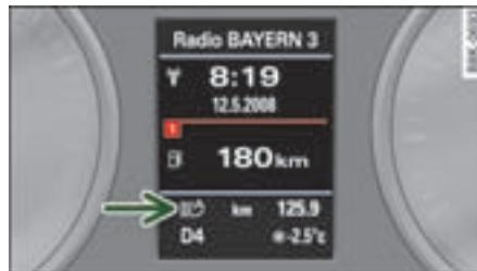
图 47 显示屏：远光灯辅助系统的指示灯
