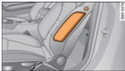
图 211 驾驶员座椅上侧面安全气囊的安装位置
