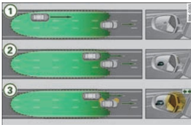
图 154 side assist 行驶换道辅助系统：慢速驶近的车辆和死角中的车辆
