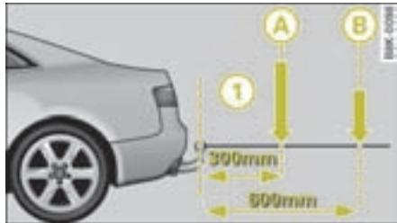
图 224 加装件和附件的载荷分布示意图
