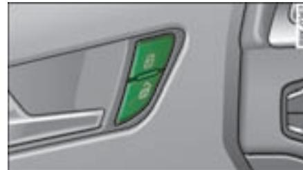
图 29 驾驶员车门：中央门锁开关
