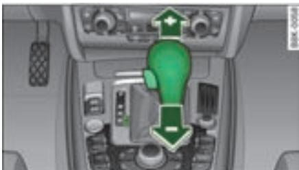
图 174 中控台：手动换档 (tiptronic 手动电控换档行驶方式)
