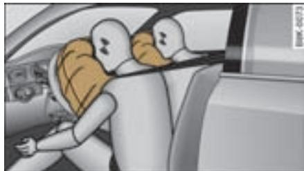
图 209 已胀开的前部安全气囊
