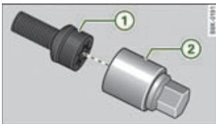
图 267 防盗车轮螺栓和适配接头
