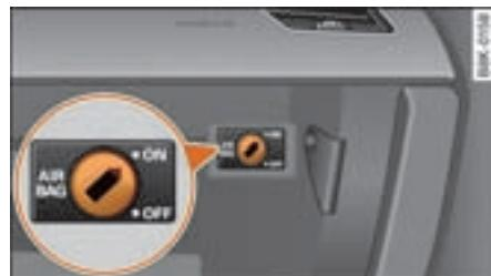
图 215 手套箱：用于关闭副驾驶员安全气囊的钥匙开关
