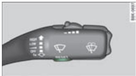
图 9 车窗玻璃雨刮操纵杆：RESET (复位) 按钮
