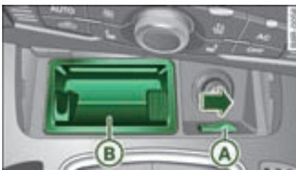
图 177 前中控台：取出烟灰缸胆
