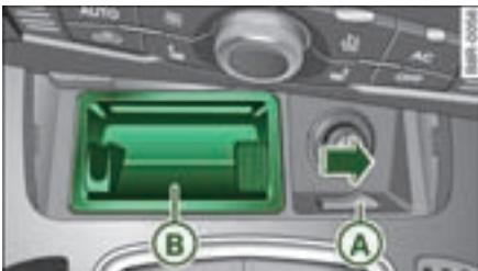
图 169 前中控台：取出烟灰缸胆
