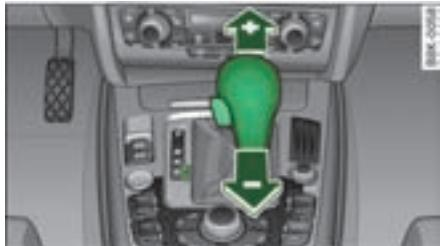
图 166 中控台：手动换档 (tiptronic 手动电控换档程序)
