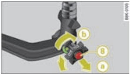
图 233 可拆卸的拖车牵引装置：拆去球节牵引杆
