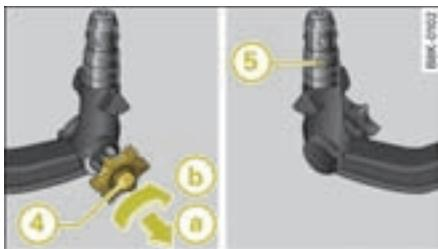
图 229 可拆卸的拖车牵引装置: 预紧球节牵引杆
