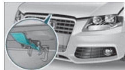
图 241 发动机舱盖下面的开启把手
