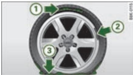
图 259 不适合使用轮胎修理包的轮胎损坏情况
