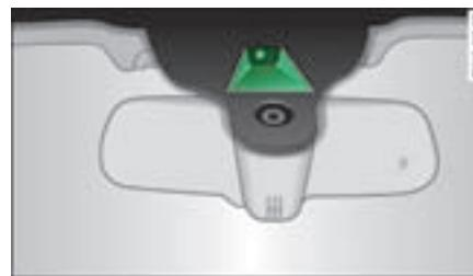
图 145 挡风玻璃：车道保持辅助系统的摄像头视窗
