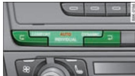
图 161 中控台：奥迪驾驶模式选择系统操作元件
