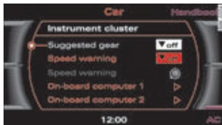
图 11 显示屏：打开 / 隐去换档建议显示
