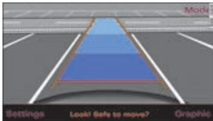
图 186 MMI 显示屏：将本车对准车位
