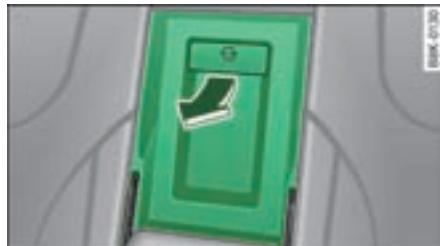
图 85 座椅靠背：滑雪板装载装置的盖板
