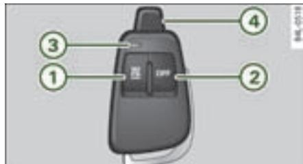
图 109 驻车暖风的无线遥控
