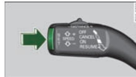
图 125 操纵杆：存储车速
