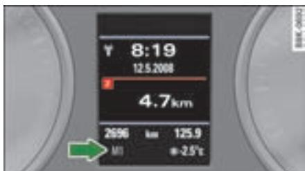
图 167 显示屏：手动换档 (tiptronic 手动电控换档程序)
