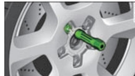
图 265 更换车轮：用于拧动螺栓的内六角头
