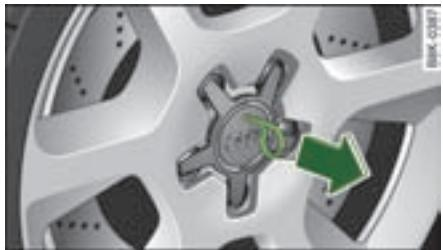
图 261 更换车轮：拉下车轮装饰罩
