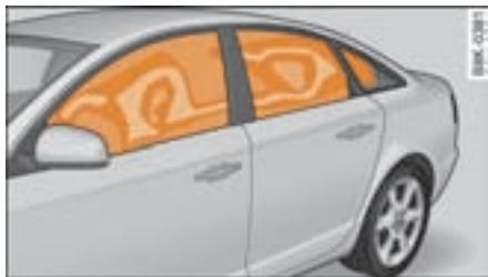
图 214 已胀开的头部安全气囊
