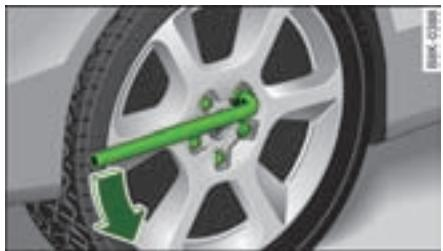
图 262 更换车轮：松开车轮螺栓
