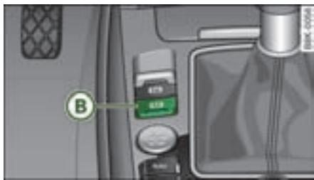
图 117 中控台局部视图: 奥迪车辆固定辅助系统按钮
