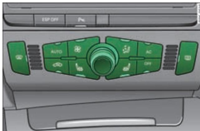
图 87 自动空调装置的操作元件
