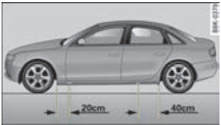
图 263 更换车轮：汽车千斤顶的安放位置
