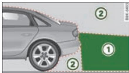
图 183 倒车摄像头的探测范围①和没有探测到的范围②
