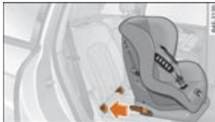
图 221 后座椅：固定有 ISOFIX 固定装置的儿童座椅
