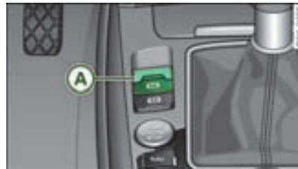
图 116 中控台：驻车制动器
