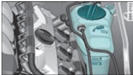
图 245 发动机舱：冷却液补偿罐上的标记
