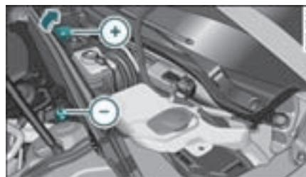
图 247 发动机舱：充电装置和辅助起动电缆的接口
