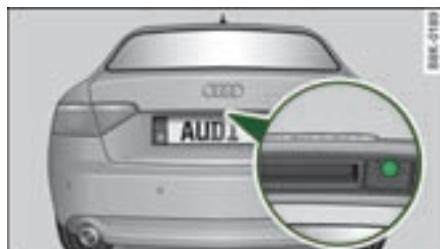
图 184 行李箱盖：倒车摄像头的安装位置
