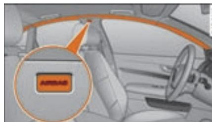
图 213 车门上方头部安全气囊的安装位置
