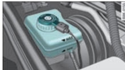
图 246 发动机舱：制动液储液罐上的标记
