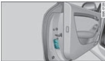
图 249 已打开的驾驶员车门及轮胎充气压力数据表
