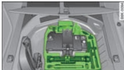
图 257 行李箱：随车工具、轮胎应急修理系统和汽车千斤顶
