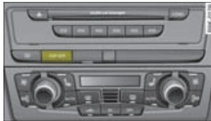
图 223 型号 B: 中控台上, ESP OFF (ESP 关闭按钮)
