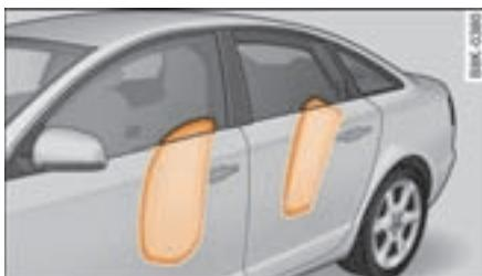
图 212 已胀开的侧面安全气囊
