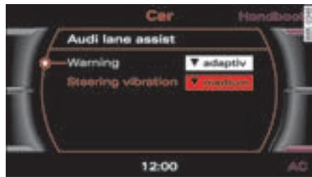
图 148 显示屏: 设置警告时间点和方向盘振动
