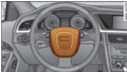
图 207 方向盘：驾驶员安全气囊
