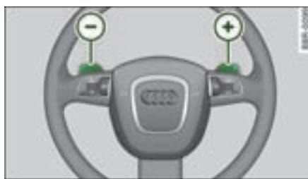
图 176 方向盘：换档翘板开关
