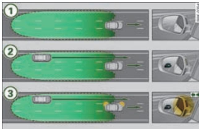
图 153 side assist 行驶换道辅助系统：有快速驶近的车辆
