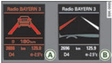
图 146 组合仪表：车道保持辅助系统开启并发出警告
