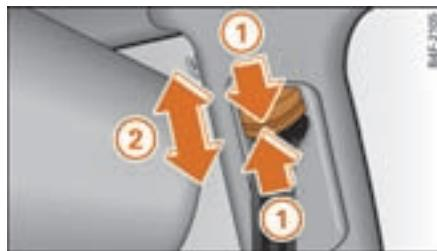
图 205 前座椅安全带高度调整机构 - 导向机构
