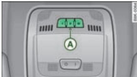
图 190 车顶篷中的操作单元
