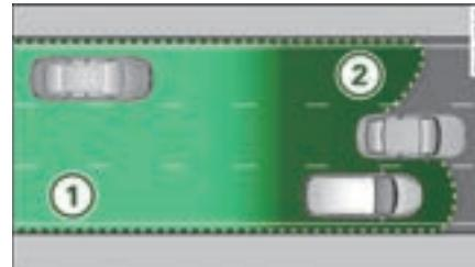
图 152 示意图：传感器的探测范围
