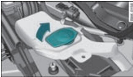
图 248 发动机舱：车窗玻璃清洗液储罐
