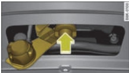
图 230 可拆卸的拖车牵引装置: 插入手轮
