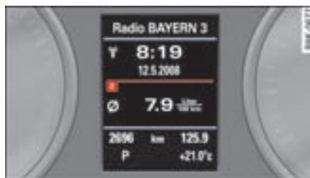
图 14 车载计算机：平均耗油量
