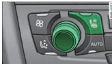
图 112 显示屏：座椅加热 / 通风
