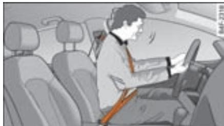
图 196 已系好安全带的驾驶员在突然刹车时被正确系上的安全带拉住
