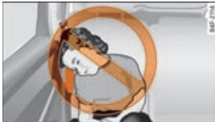
图 217 侧面安全气囊展开部位的危险坐姿图解。
