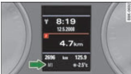
图 175 显示屏：手动换档 (tiptronic 手动电控换档行驶方式)
