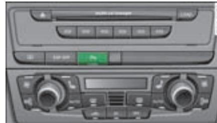
图 179 中控台：驻车辅助功能开关
