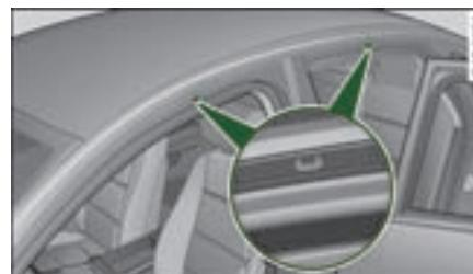
图 79 用于车顶行李架的固定点
