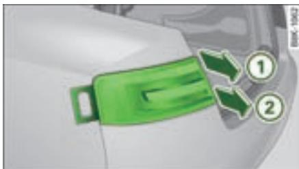
图 291 拆卸侧围板中的尾灯
