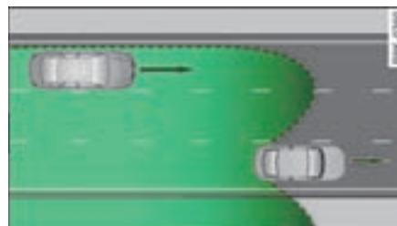
图 159 狹窄车道：行驶换道辅助系统可能对隔道行驶的车辆作出反应
