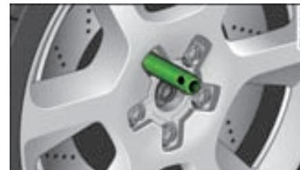
图 266 更换车轮：最上面一个孔内的定位销
