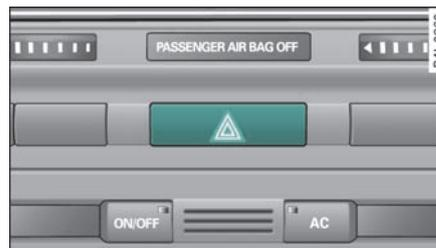
图 48 中控台：用于闪烁报警装置的开关
