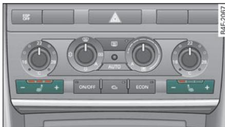
图 110 驾驶员座椅和副驾驶座椅的加热装置
