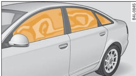
图 207 已胀开的头部安全气囊
