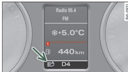
图 46 远光灯辅助系统的指示灯
