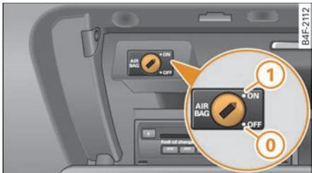
图 208 手套箱中用于关闭副驾驶安全气囊的钥匙开关
