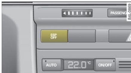
图 216 中控台：ESP OFF 按钮
