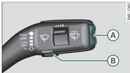
图 17 车窗玻璃刮水操纵杆：车载计算机的操作元件
