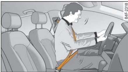
图 189 已系好安全带的驾驶员在突然刹车时被正确系上的安全带拉住
