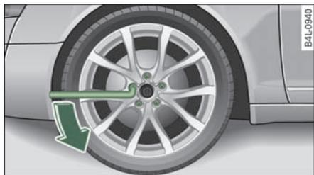
图 251 更换车轮：松开车轮螺栓
