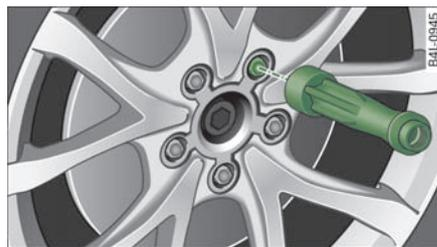
图 254 更换车轮：用于拧动螺栓的内六角头
