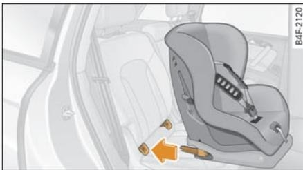
图 215 后座椅：固定带有 ISOFIX 固定装置的儿童座椅
