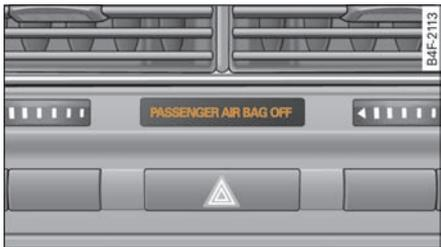
图 209 在用钥匙开关关闭副驾驶安全气囊时的警告灯
