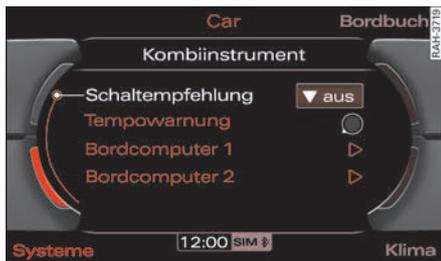
图 11 显示屏：打开 / 关闭换挡建议显示
