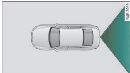
图 172 俯视图：倒车摄像头的探测范围
