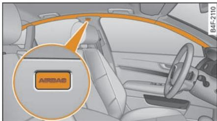
图 206 车门上方头部安全气囊的安装位置
