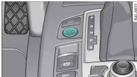
图 119 中控台：发动机启动按钮
