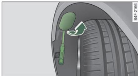
图 266 前部车轮罩：靠近前部转向信号灯灯泡
