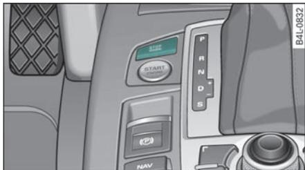
图 120 中控台：发动机关闭按钮
