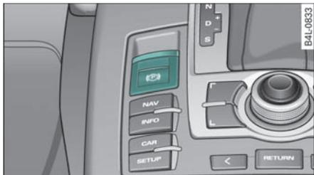
图 121 中控台：驻车制动器
