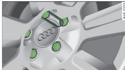
图 250 更换车轮：拆下封盖
