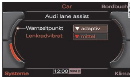
图 148 显示屏：设置警告时间点和方向盘振动 ▶
