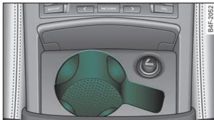
图 75 中控台：前部饮料托架
