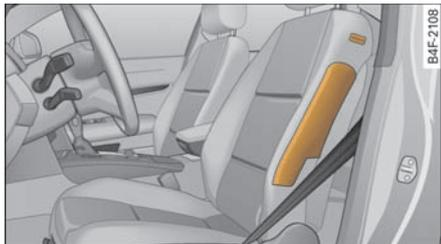
图 204 驾驶员座椅上侧面安全气囊的安装位置
