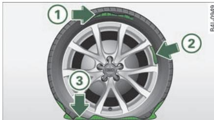
图 257 不适合使用轮胎应急套件的轮胎损坏情况
