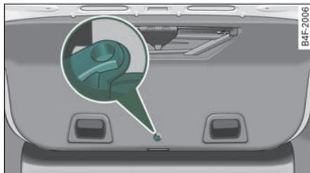
图 32 行李箱盖局部视图：应急开锁操作口
