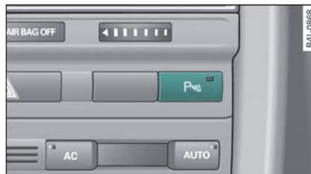
图 168 中控台：驻车辅助开关
