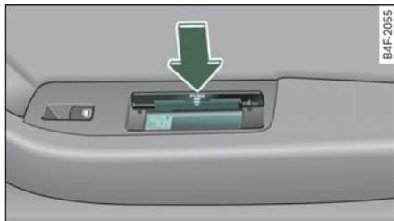
图 71 后车门饰板：后部烟灰缸
