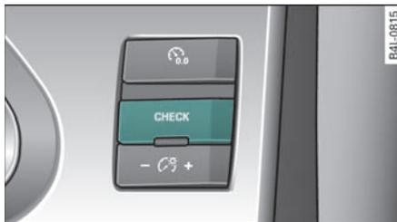
图 122 组合仪表局部视图：CHECK（检测）按钮
