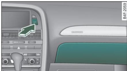
图 77 中控台：手套箱的开锁按钮
