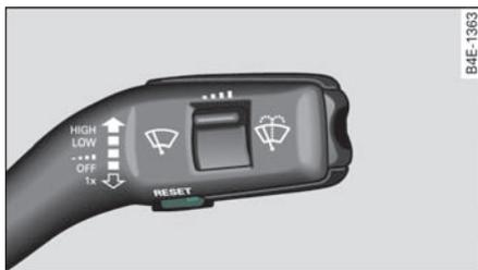
图 9 车窗玻璃刮水操纵杆：RESET(复位)按钮
