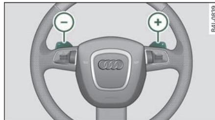
图 165 方向盘：手动电控换档程序开关
