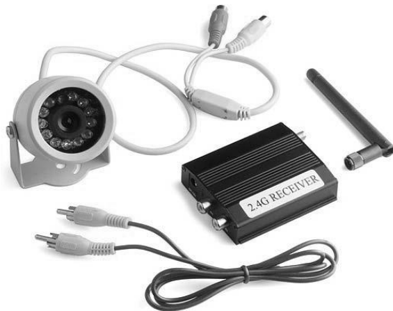
图 2-28 从 Sparkfun.com 购买的 2.4GHz 无线摄像头（零件号 WRL-09189），大约 75 美元，是一种为机器人添加一对远程眼睛和耳朵的好方式
