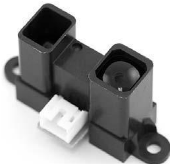
图 2-22 这是一个夏普 GP2 红外线测距仪（ Sparkfun.com 零件号 SEN-08958）
