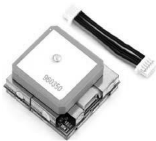
图 2-27 从 Sparkfun.com 购买的 EM406 GPS 传感器（零件号 GPS-00465）可以直接连接到 Arduino ，用来制作自主导航车辆（例如本书第 9 章的机器船）
