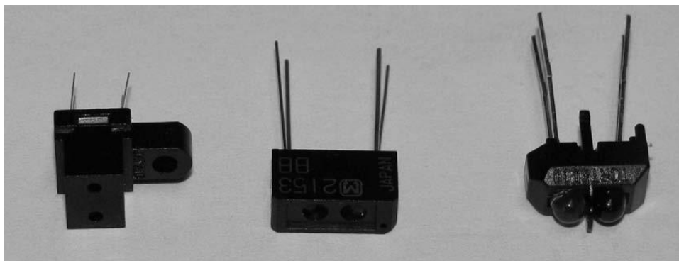
图 2-23 这是三种不同类型的红外线发射器和探测器对。最右边的红外线对用于莱纳斯，这是一种第 4 章将介绍的寻线追踪机器人。这些传感器的价格范围从 1 美元到 3 美元不等，可以从 Digikey.com 上买到
