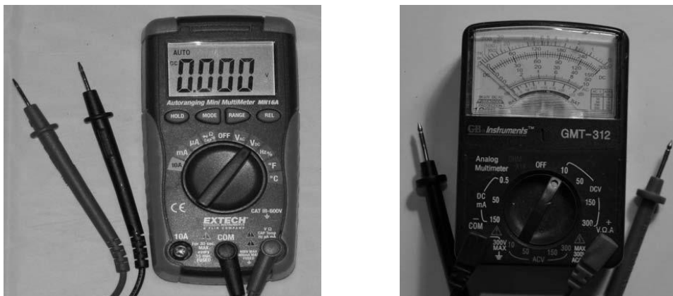
图 1-5 华仪 MN16a 型数字万用表（左）可以测量交流电和直流电的电压、电阻、连续性（即电路通不通）、二极管测试、电容、频率、温度和高达 10A 的电流。本地五金店购买的廉价模拟万用表（右）可以测量交流电和直流电的电压、电阻（1k \Omega ）和至多 150mA（0.15A）的电流。不管是诊断 Arduino，还是其他大多数的电路——你肯定需要一个万用表
