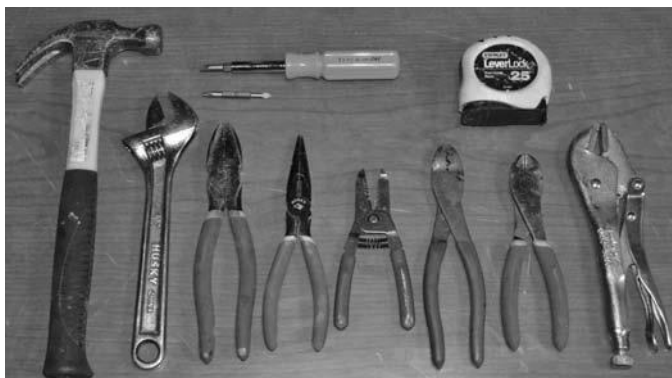
图 1-28 基本的工具箱 ：多功能 6 合 1 螺丝刀（上排中间）、25 英尺 的卷尺（上排右侧）， （从左到右）锤子、活动扳手、边裁 钳 、尖嘴钳、剥线钳、压线钳、剪线钳和万能 钳
