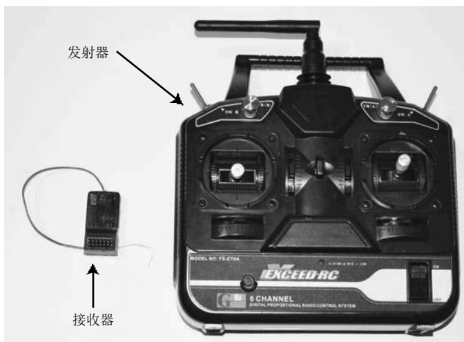
图 2-19 这是个玩具型 2.4GHz 的无线电系统，包含一对六信道发射器和接收器，可以以不到 40 美元的价格从 HobbyPartz.com 上买到（零件号 79P-CT6B-R6B）
