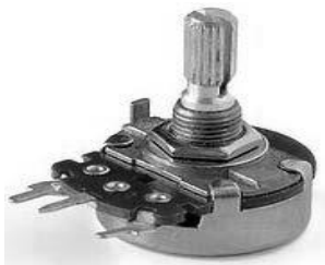
图 1-19 这个典型的旋转式电位器有三个端。外面的两个端应该分别连接到接地端和+5V（方向无所谓），而中间端应该连接到 Arduino 上的模拟输入引脚
