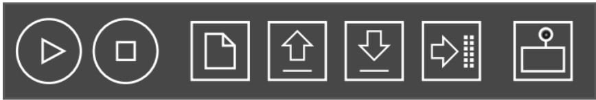
图 1-17 在 IDE 顶部有一个包含常见任务快捷键的工具栏。当使用 IDE 时，将鼠标光标悬停在每个按钮上就可以看见相应的描述
