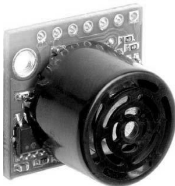
图 2-24 MaxBotix LV-EZ0 型号的超声波探测仪，有效探测范围为 6 英寸到 25 英尺（Sparkfun.com 零件号 SEN-08502）
