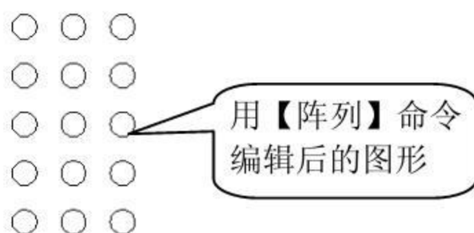
例 04-3 使用【阵列】命令复制圆形，最终结果如下图所示。
