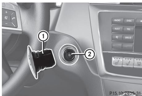
可以从点火开关中取下启动/停止按钮，并用钥匙正常启动车辆。
