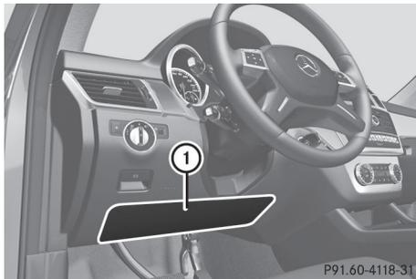
驾驶员膝部气囊 ① 在转向柱下方触发，其通常与驾驶员前置气囊一起触发。发生正面碰撞时，驾驶员膝部气囊能够在超过一定触发界限后与前置气囊一起触发。该膝部气囊在驾驶员坐姿正确并正确佩戴安全带时能够发挥最佳作用。
