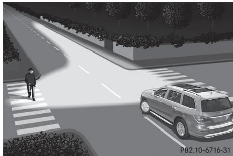
转角照明灯功能可沿车辆转弯方向在较大范围内改善路面照明效果，例如可在急转弯时提供更好的视野。该功能只能在近光灯开启时启用。
