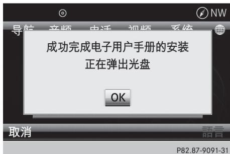
▶ 当安装完成时：按下 驾驶室管理及数据系统（COMAND）控制器确认安装 CD 已弹出。
