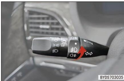
■ 开启后雾灯：将雾灯旋钮从 $\bullet$ 位置向下旋至 $\text{O}$ 位置，然后松开即可。
