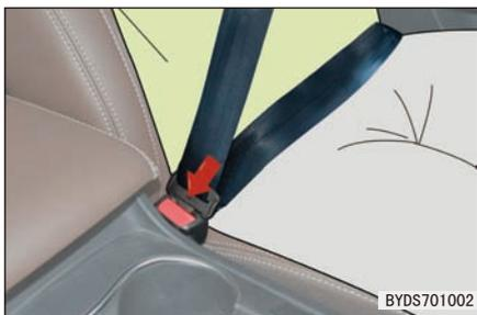
4. 调整安全带高度调节器（前排）至合适位置，以获得最佳舒适性和保护作用。安全带位于肩部中间位置时保护作用最佳，不应触及颈部或从肩部滑脱。
