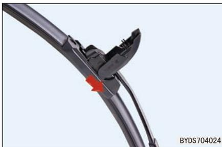
4. 再移动刮片，让刮杆从刮片美观盖孔处脱出来，此时整个刮片已经取下。
