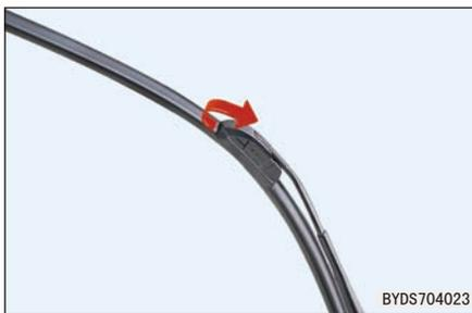
3. 握住刮片卡扣处，沿图示方向用力，将刮片从刮杆弯钩脱出来。
