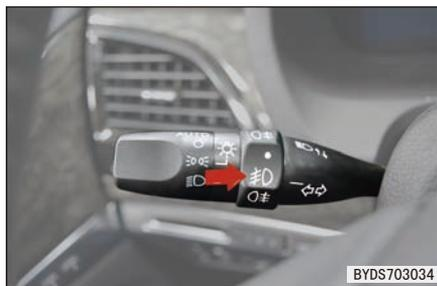
开启前、后雾灯：开启前雾灯后，将开关旋至 $\text{O}$ 位置，然后松开即可，此时仪表盘上的 $\text{O}$ 指示灯点亮。
