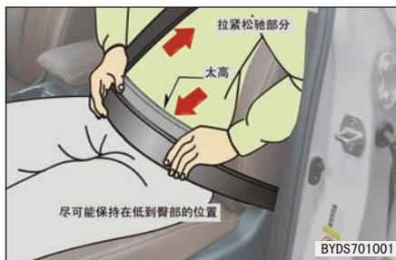
3. 将锁舌插入带扣，直至听到“咔嗒”声，反方向拉锁舌，确认锁止成功。注意安全带不能扭曲。
