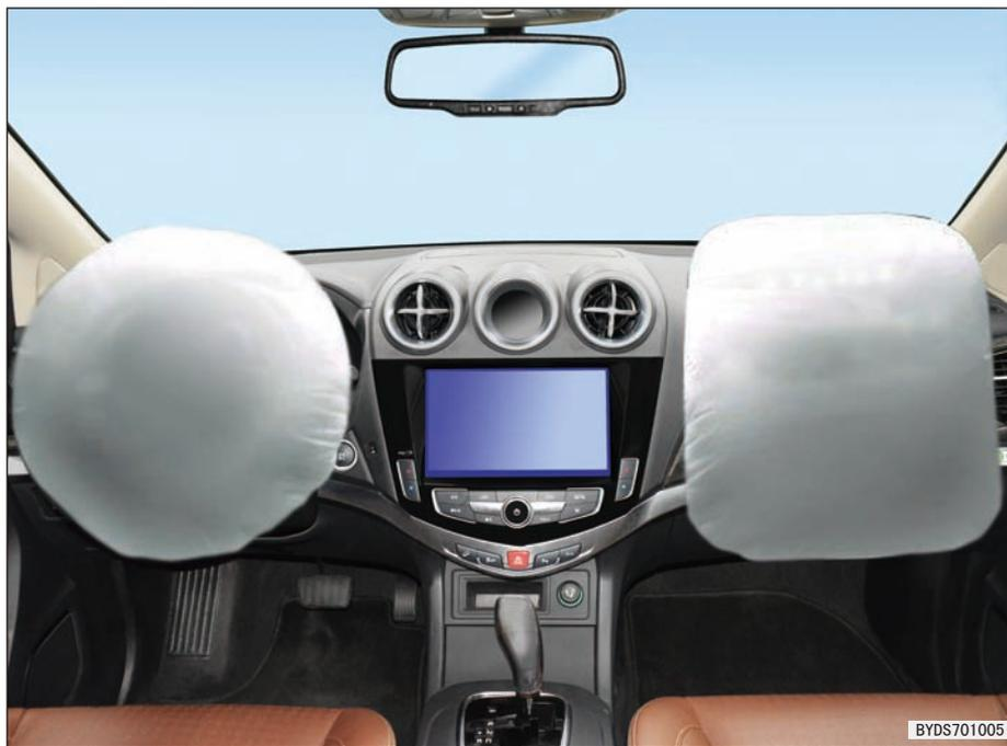
如果您选择的车辆上配置有正面安全气囊辅助保护装置，包括驾驶员安全气囊和前排乘员安全气囊，在行车中遇到中等至严重程度的正面撞击时，安全气囊将会展开用来协助保护您和前排乘员的头部及胸部，以减少您受伤害的程度。
