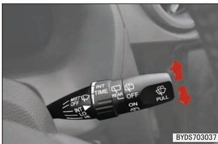
在间歇挡位时，可旋转间歇时间调节旋钮，随着刮刷速度条的变窄，其刮水间歇时间分别为 1s、3s、5s 和 7s。
