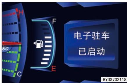
请踩下制动踏板，解除电子驻车
