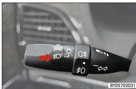
■ 灯光开关末端旋钮转至“**AUTO**”位置，可点亮近光前照灯及小灯。根据光照强度传感器所感受到的光照强度情况，这些灯自动点亮或熄灭。
