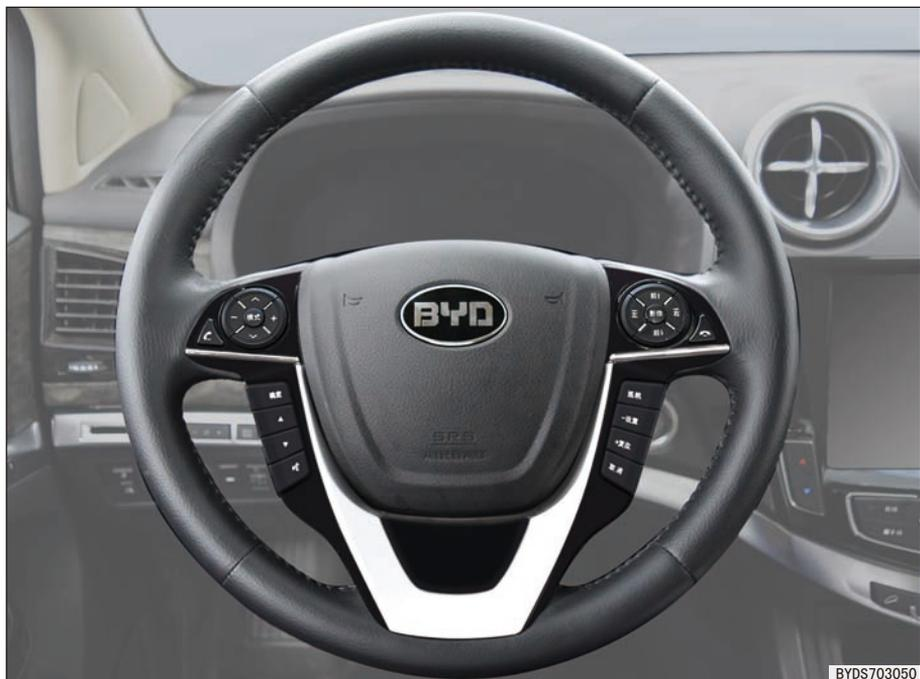
电源挡位处于“ACC”及“ON”挡时音响控制开关可用。
