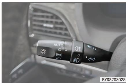
灯光开关末端旋钮转至○位置，所有灯光都关闭。
