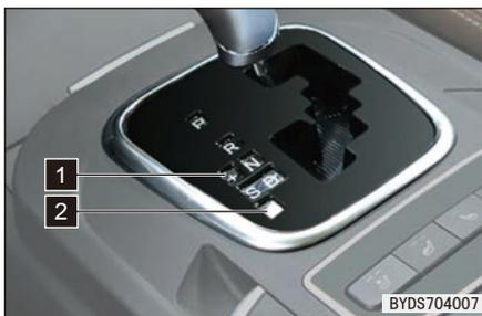
**2** -：调低挡位。变速箱控制单元 (TCU) 会根据当前车速状况进行判断后，则变速器挡位会相应降低，直到变速器处于最低挡位 (1 挡) 为止。
