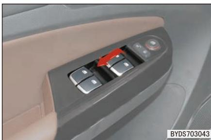
当按下此开关时，右前门、左后门、右后门上的玻璃升降器开关将不起作用，同时这三个按键上的工作指示灯熄灭。再次按此开关，按键升起，恢复右前门、左后门、右后门上的玻璃升降器开关功能，同时这三个按键上的工作指示灯点亮。
