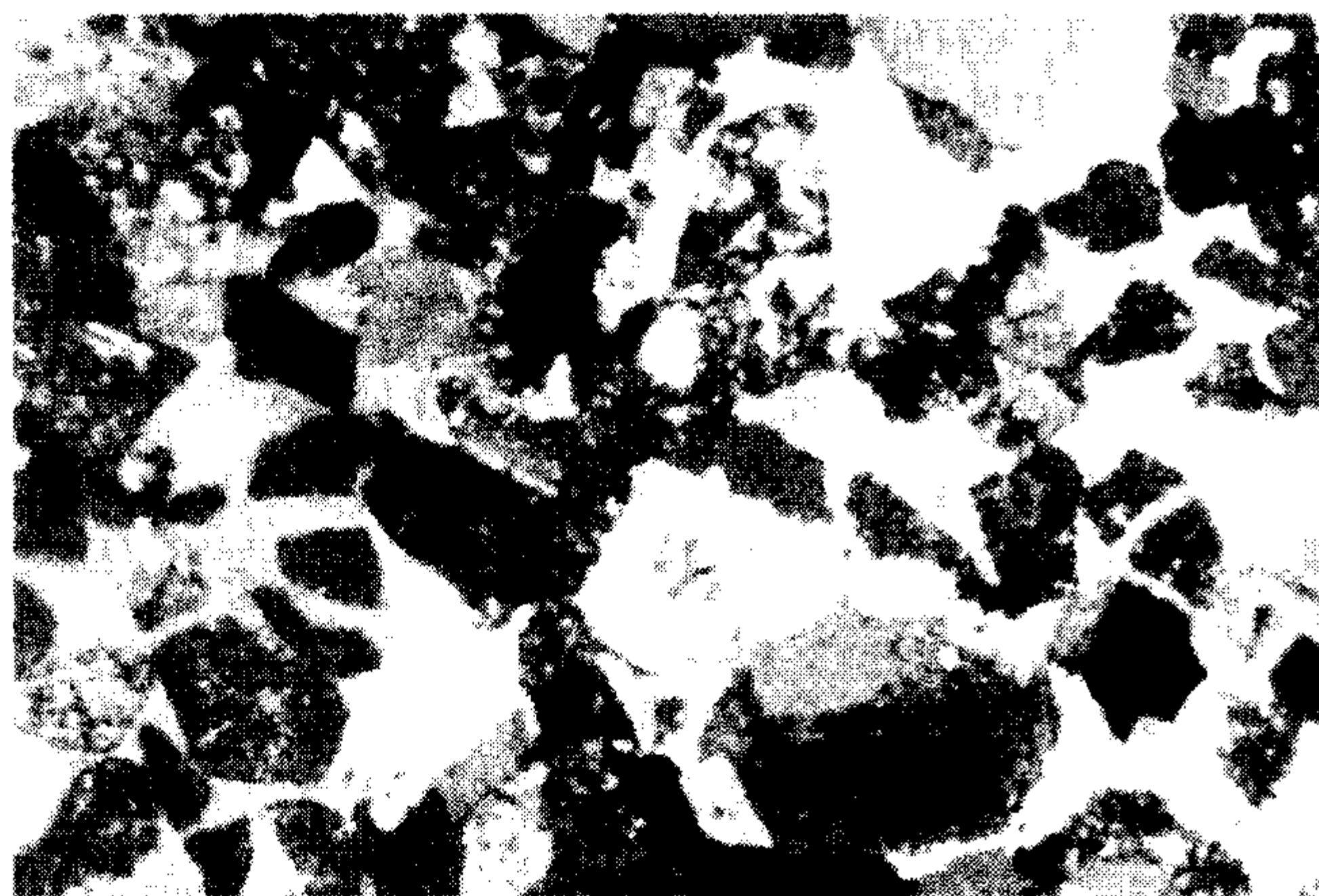
图 9-5 钙质岩屑砂岩，方解石呈嵌晶式胶结 (二连盆地，哈 4 井，下白垩统，正交光， \times 40 )
