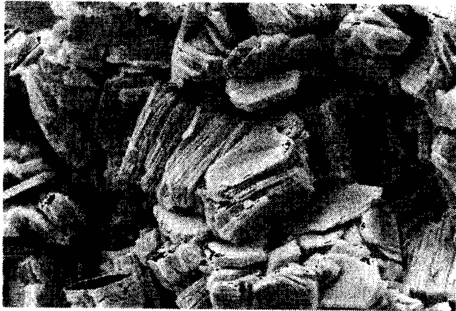
图 8-2 电子显微镜下的高岭石 (准噶尔盆地, 二叠系, ×3000)
