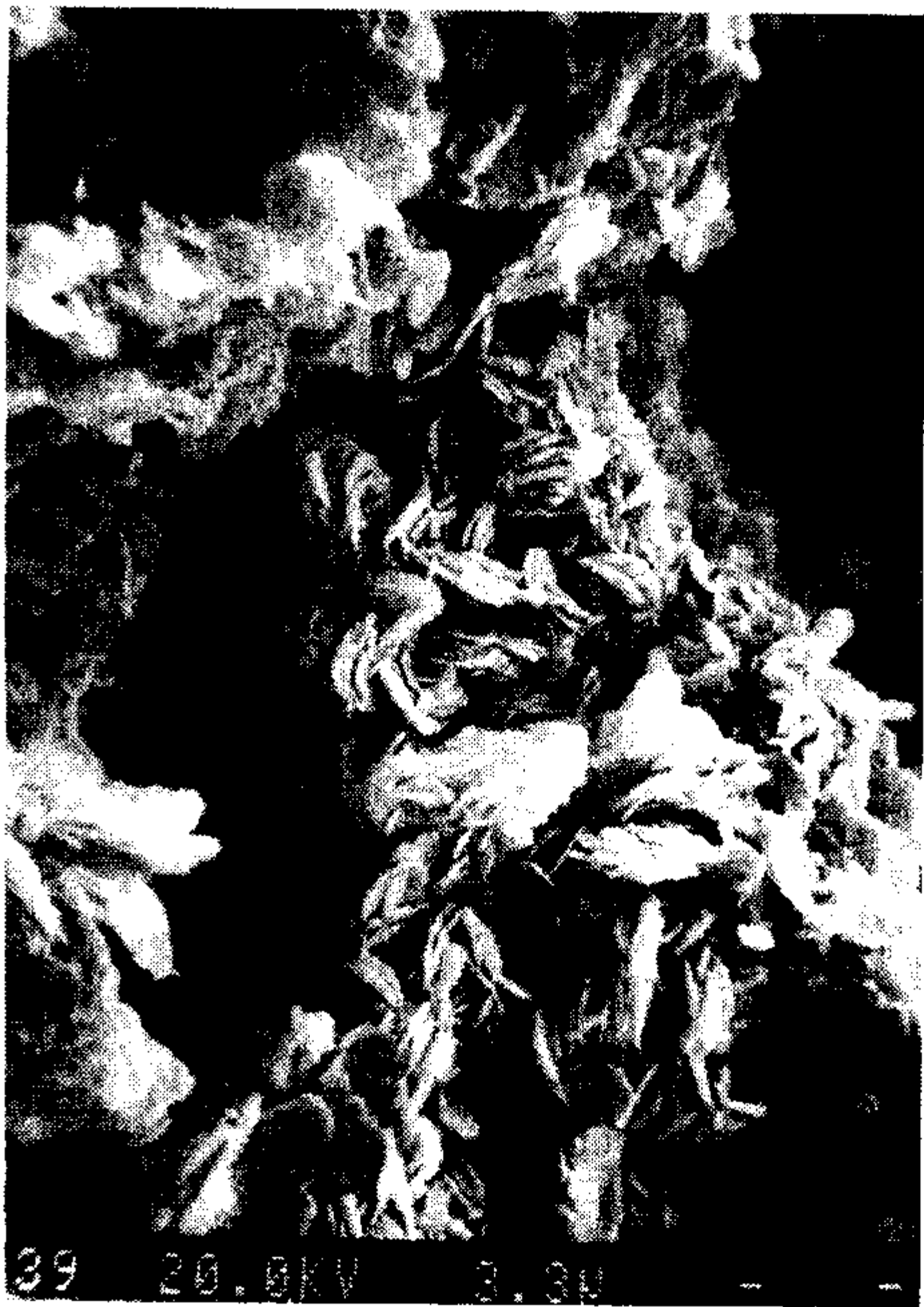
图 8-5 电子显微镜下的绿泥石 (准噶尔盆地, 三叠系, ×4000)
