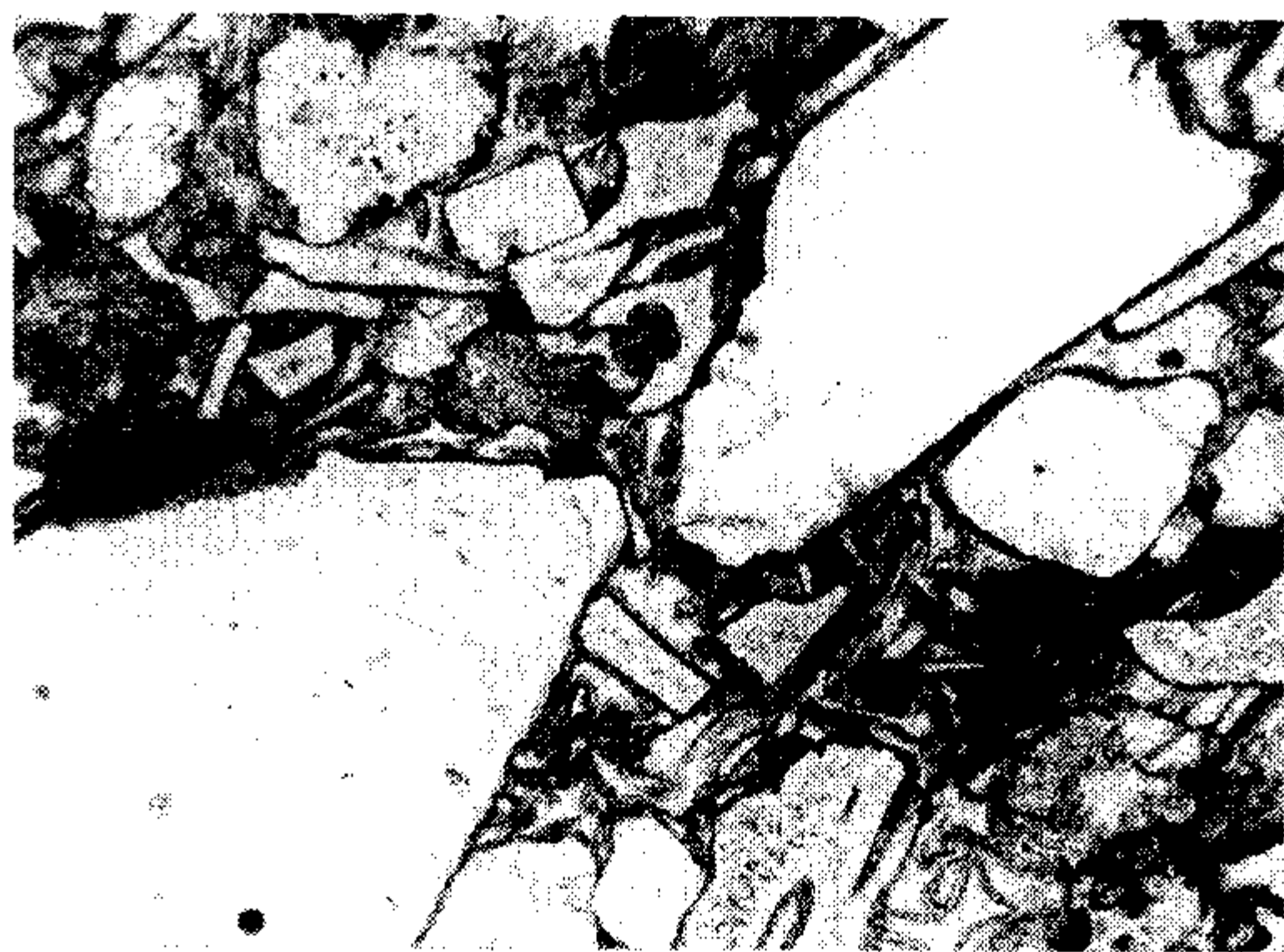
图 10-9 沸石化沉凝灰岩 (河北宣化, 白垩系, 单偏光, ×40)
