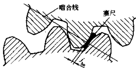
图 2-136 用塞尺测量侧隙(法向平面)
