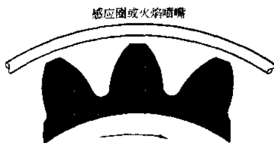
图 10-5 A 型：非齿廓型硬化
