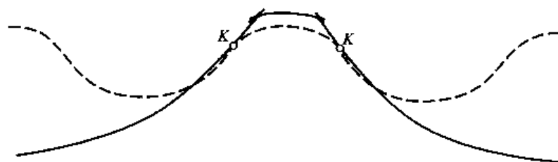
图 7-64 顶部摆线与工作齿形两次相交
