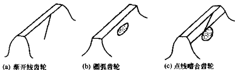
图 3-11 三种齿轮的接触状态
