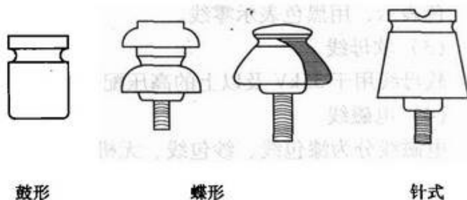
图 15-3 常用的低压绝缘子
