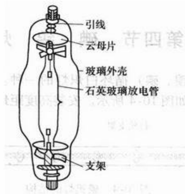
图10-6 金属卤化物灯的结构
