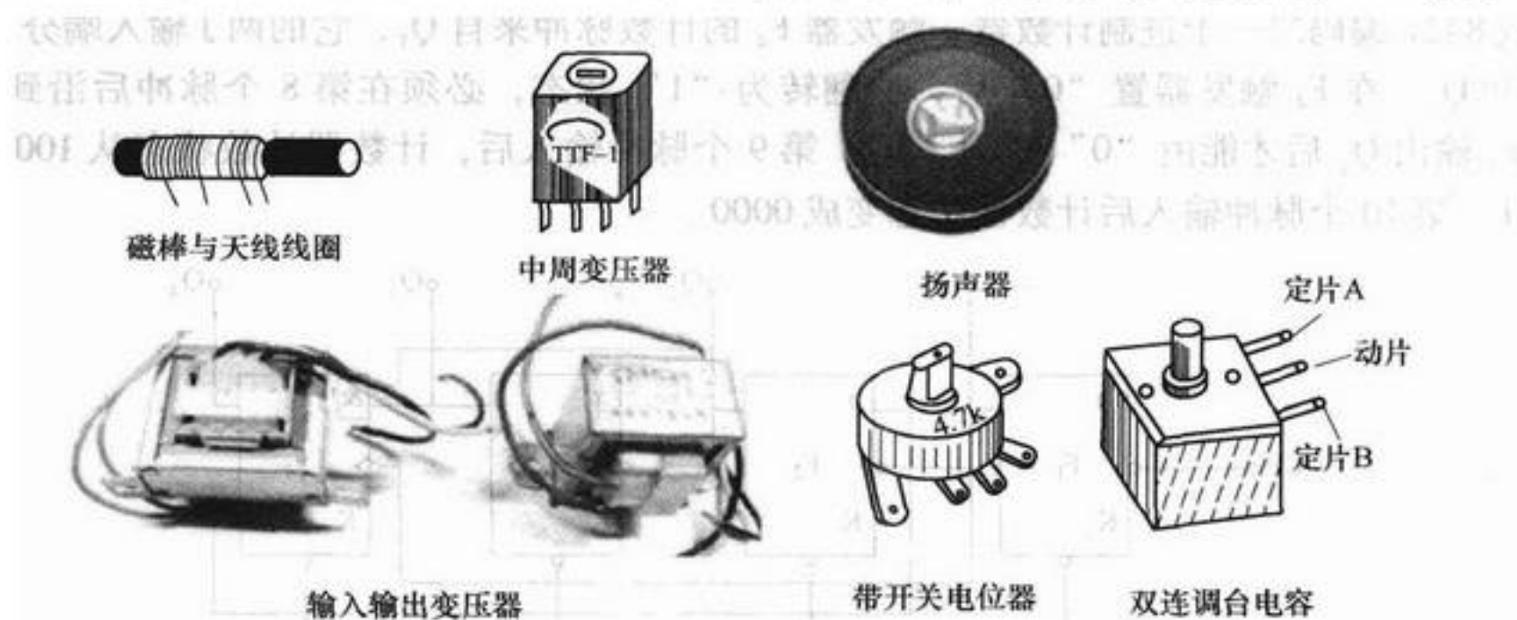
图 3-11 收音机部分元器件
