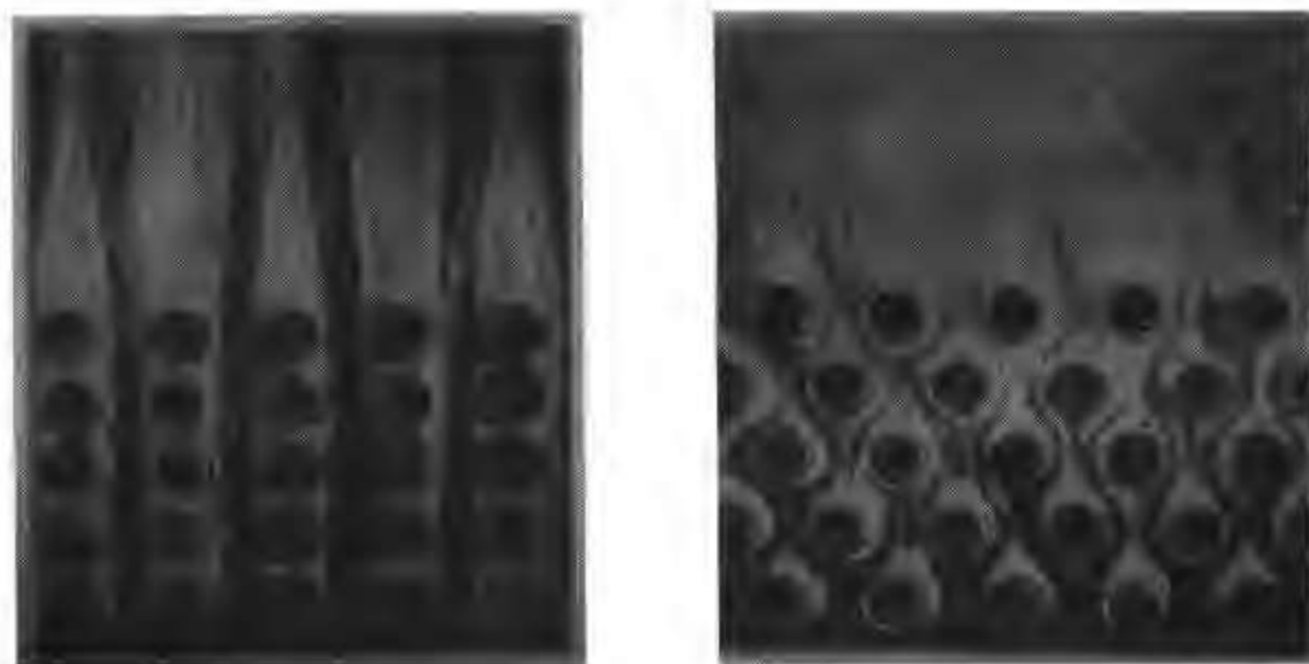
图 6-14 流体横掠管束的流动可视化图像 [25]
