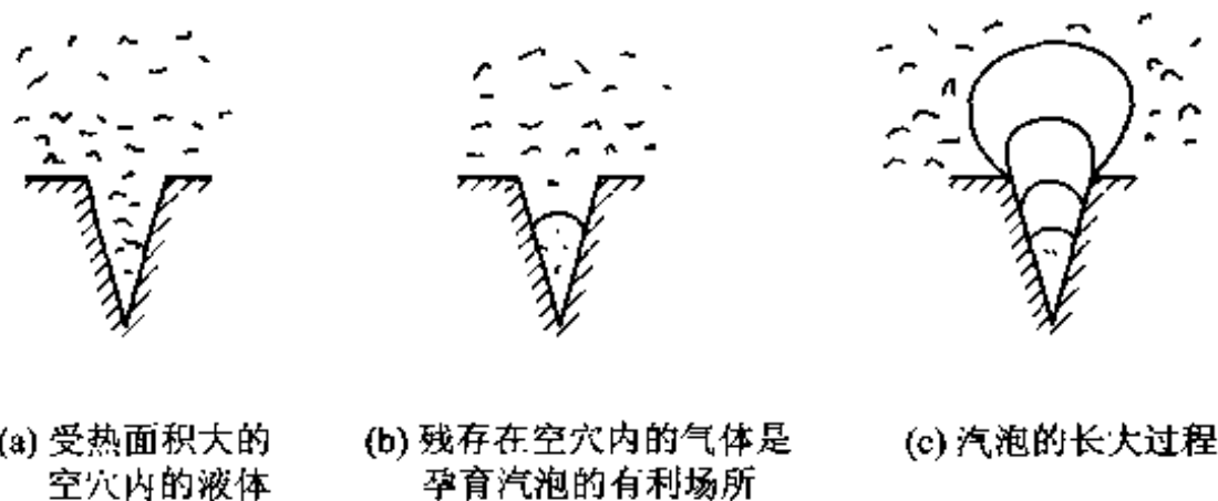
图 7-16 加热面上最有利于成为汽化核心的地点及汽泡的成长
