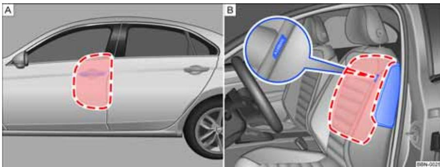
图 62 A: 轿车左侧 - 侧面安全气囊膨胀范围; B: 左前座椅侧面 - 侧面安全气囊安装位置及膨胀范围
