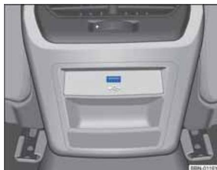
图 92 部分车型后排出风口下方的 USB 输入端
