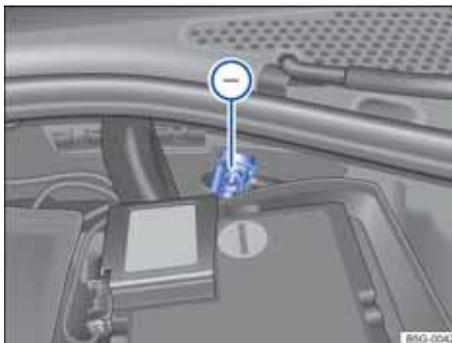
图 214 用于充电器负极连接的接地点
