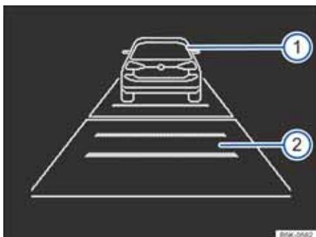
图 145 组合仪表显示屏：已暂时关闭自适应巡航系统（ACC）控制功能，已探测到的前方车辆，设定的距离间隔
