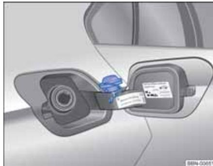
图 177 拧下的加油口盖可挂在打开的燃油箱盖板上
