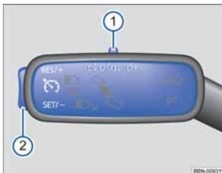
图 141 转向柱左侧：定速巡航系统操作开关及按钮
