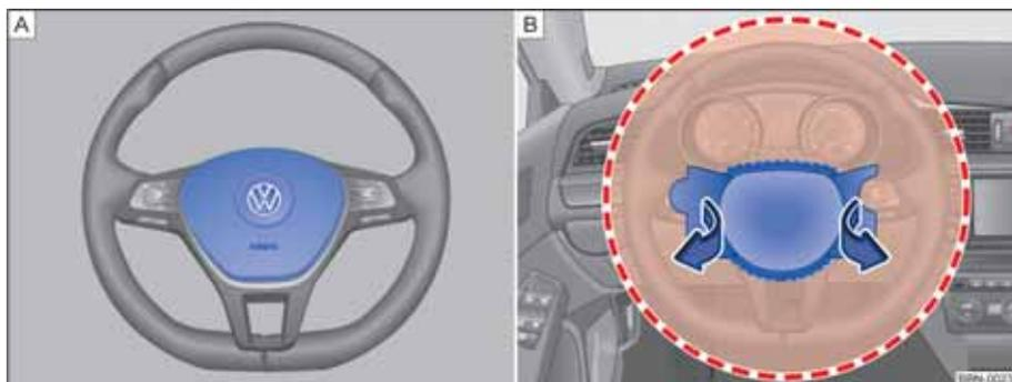
图 60 驾驶员前部安全气囊的安装位置和膨胀范围。
