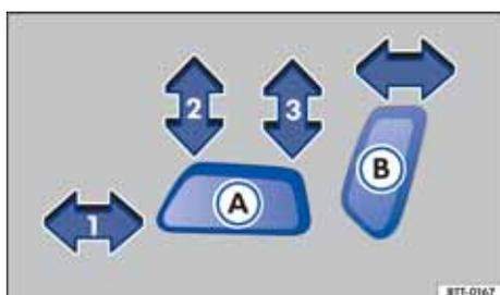
图 39 开关：调整座椅的前后位置、座椅面的高度和倾斜角度
