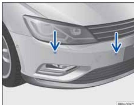
图 137 右前保险杠上智能泊车辅助系统的传感器和驻车距离报警系统的传感器
