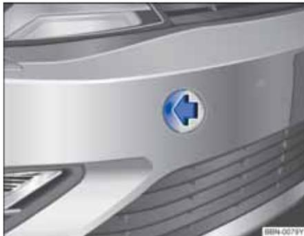
图 215 在保险杠的右前部：拆卸盖板
