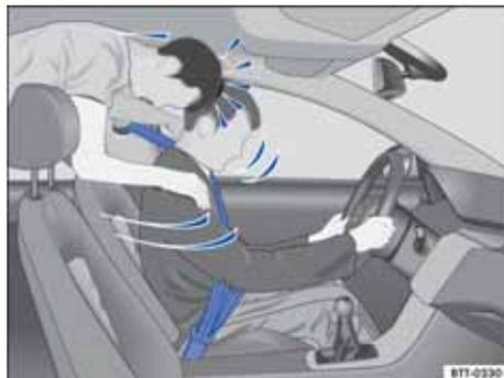
图 53 未系安全带的后排乘员被猛烈前抛，撞击佩戴安全带的驾驶员
