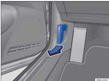
图 179 驾驶员侧脚部空间：发动机舱盖锁开启手柄
