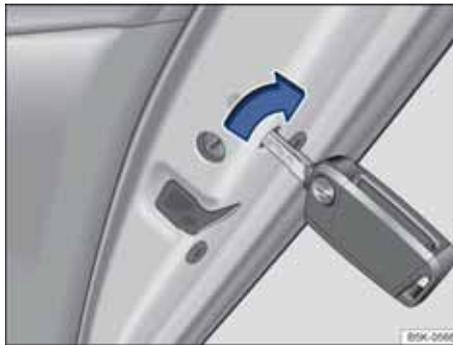
图 199 车门应急上锁装置及汽车钥匙
