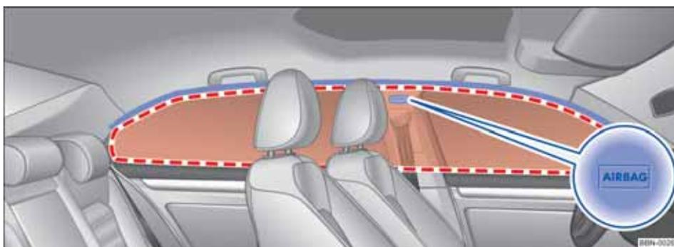
图 63 在汽车左侧: 头部安全气囊的安装位置和膨胀范围
