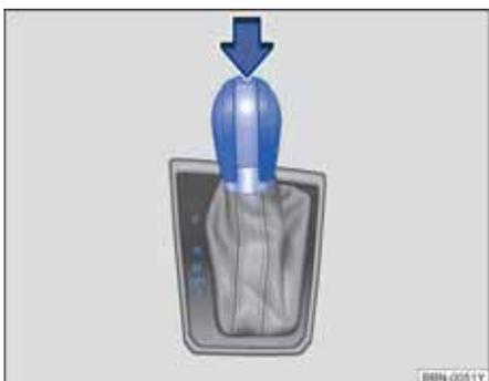
图 108 带锁止按钮（箭头所示）的自动变速箱选档杆。
