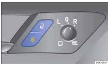
图 25 驾驶员侧车门内：中央门锁按钮。
