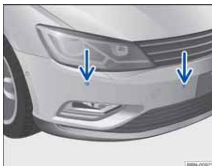
图 129 右前保险杠上智能泊车辅助系统的传感器和驻车距离报警系统的传感器
