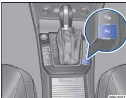
图 115 在中控台中：用于接通或关闭前后驻车距离报警系统的按钮。
