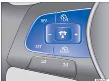
图 144 多功能方向盘左侧：车速限制器操作按钮
