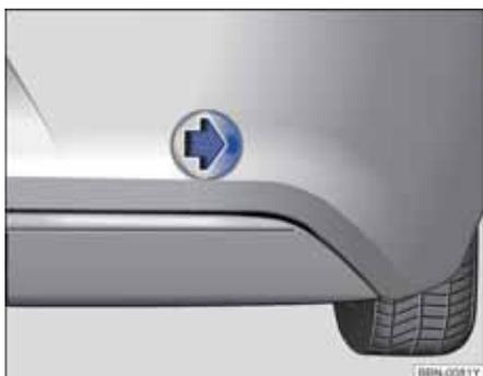
图 217 在保险杠右后部：拆卸盖板
