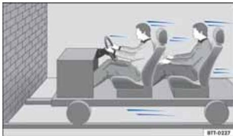
图 50 汽车驶向一砖墙，驾乘人员未系安全带
