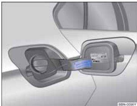
图 178 油箱加油口盖板内侧的标签
