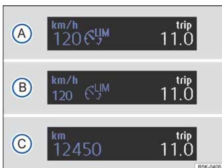
图 143 组合仪表显示屏：车速限制器状态显示模式
