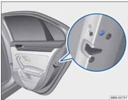
图 198 左侧后车门端面处的应急上锁装置（由橡胶密封件遮盖着）
