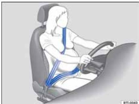
图 58 正确的孕妇安全带佩戴走向。
