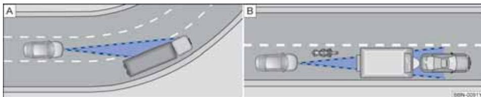
图 149 (A) 处在弯道里的轿车; (B) 前方行驶的摩托车处在雷达传感器探测范围外
