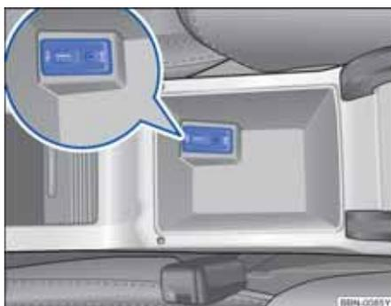
图 91 中央扶手内的 USB、AUX IN 输入端
