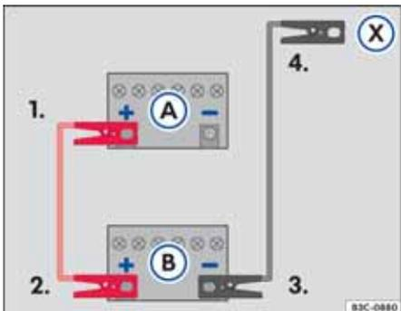
图 213 跨接电缆连接示意图
