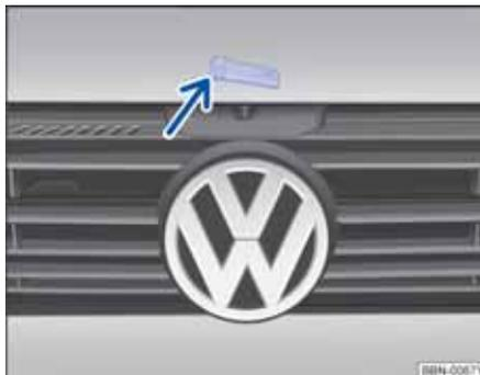
图 180 散热器格栅上方用于打开发动机舱盖的分离杆
