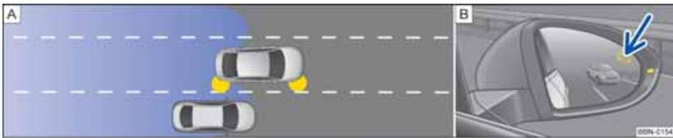
图 161 原理图：(A)：超车和并道的行驶状况。(B)：右侧车外后视镜上的盲区监控传感器显示
