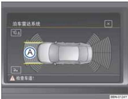
图 119 驻车距离警报系统显示屏：未施加转向时轿车行驶路径显示模式
