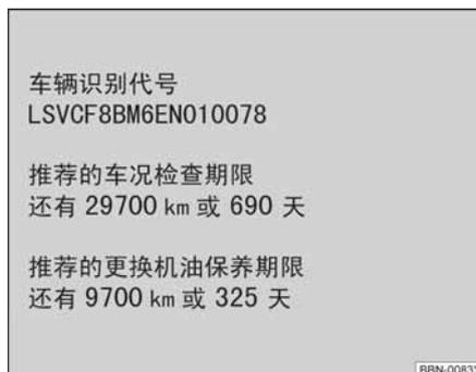
信息娱乐系统显示的保养信息示例。上方显示“车辆识别代号 LSVCF8BM6EN010078”。中间显示“推荐的车况检查期限 还有 29700 km 或 690 天”。下方显示“推荐的更换机油保养期限 还有 9700 km 或 325 天”。右下角有代码“BBN-0083Y”。
