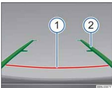
图 123 显示屏上：车后停车位静态定向线
