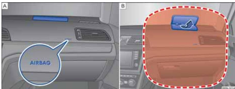
图 61 副驾驶前部安全气囊的安装位置和膨胀范围。
