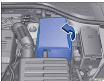
图 185 拆卸蓄电池护盖
