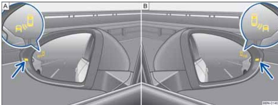
图 158 车外后视镜内：盲区监控传感器显示
