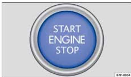
图 103 无钥匙系统 Kessy：中控台下部分中的启动按钮。
