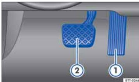
图 106 带自动变速器的汽车上的踏板：① 油门踏板、② 制动踏板。
