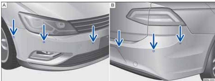
图 116 前后保险杠：驻车距离报警系统超声波传感器
