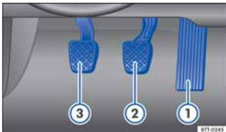
图 105 带手动变速器的汽车上的踏板：① 油门踏板 ② 制动踏板 ③ 离合器踏板
