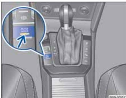
图 113 在中控台中：自动驻车功能按钮。
