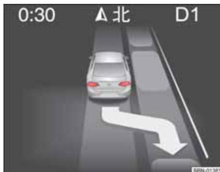
图 127 显示：识别到停车位，同时提示挂入倒档
