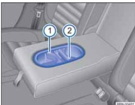
图 96 后排中央扶手上的饮料杯支架
