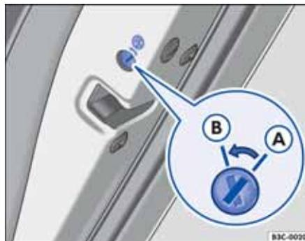
图 29 在右后车门中：儿童安全锁
