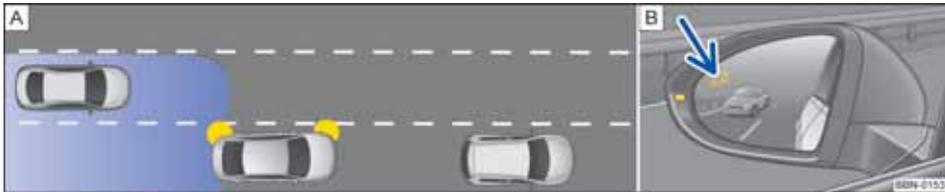
图 160 原理图：(A)：后方有车超车的行驶状况。(B)：左侧车外后视镜上的盲区监控传感器显示
