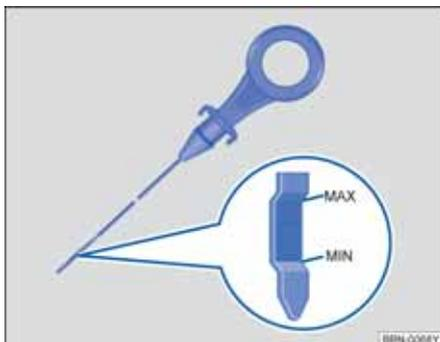
图 181 带液位标记的机油标尺
