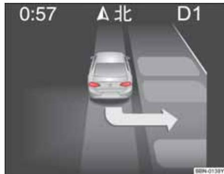
图 135 显示：识别到停车位，同时提示挂入倒档
