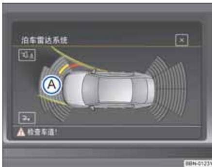
图 120 驻车距离警报系统显示屏：施加转向时轿车行驶路径显示模式
