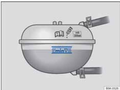
图 183 冷却液补偿容器上的液位标记
