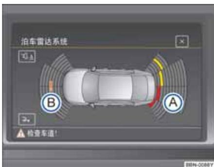
图 117 显示屏显示：车周区域驻车距离警报系统图像
