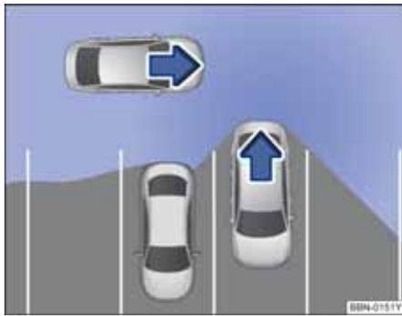
图 162 倒车侧视辅助原理图：车辆驶出停车位时的四周监控范围
