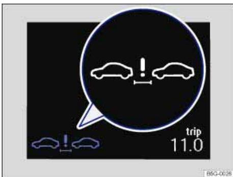
图 151 组合仪表显示屏中：车距预警显示
