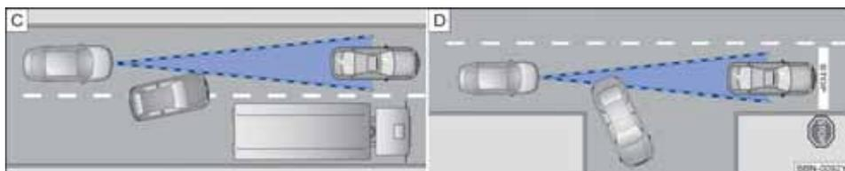
图 150 (C) 正在变换车道的其它车辆; (D) 正在转弯和处于静止状态的其它车辆
