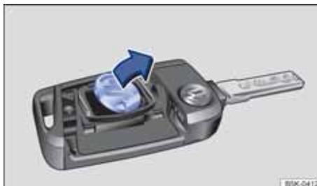
图 23 轿车钥匙：取出旧电池
