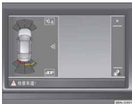
图 118 显示屏显示：车周区域驻车距离警报系统缩微图像
