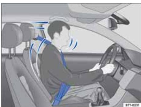
图 54 紧急制动时正确佩戴的安全带可有效保护驾驶员
