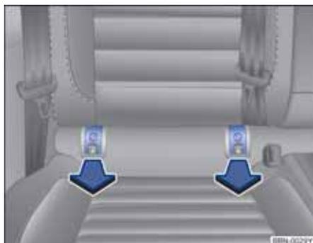
图 66 汽车座椅上：下部固定点护罩
