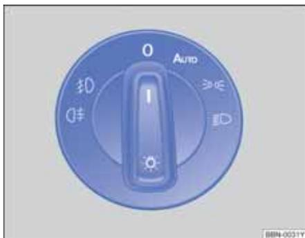
图 69 仪表板局部视图：灯光开关
