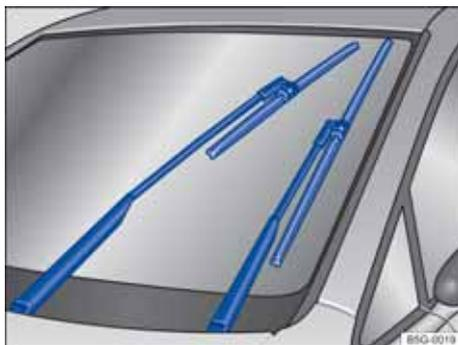
图 75 车窗玻璃刮水器在维护位置。
