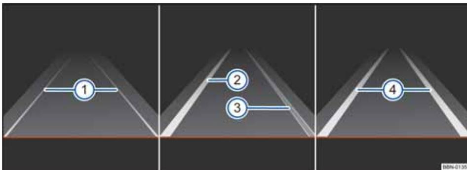
图 156 组合仪表显示屏：车道保持系统显示模式
