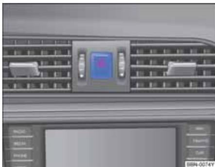
图 194 在中控台上方部分中：危险警报灯开关。
