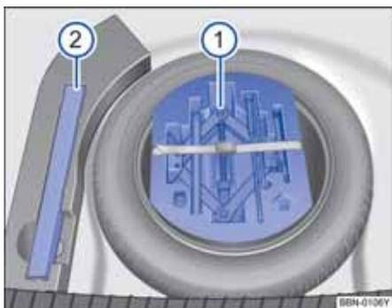
图 201 行李厢垫下的备用轮胎及随车工具
