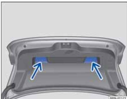
图 32 已打开的行李厢盖：用于关上的凹槽。
