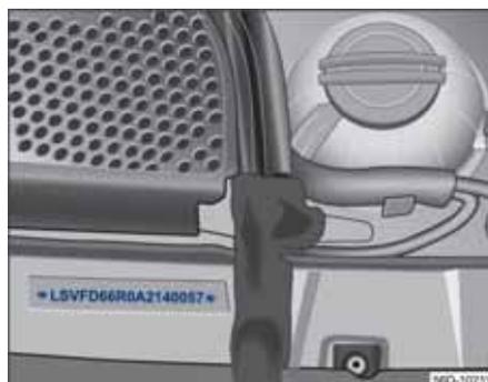
图 19 发动机舱内的底盘号钢印位置
