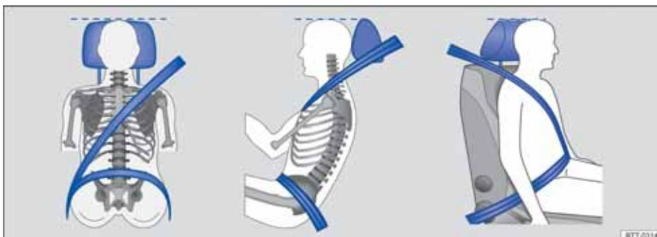
图 57 正确的安全带佩戴走向和正确的头枕调节。
