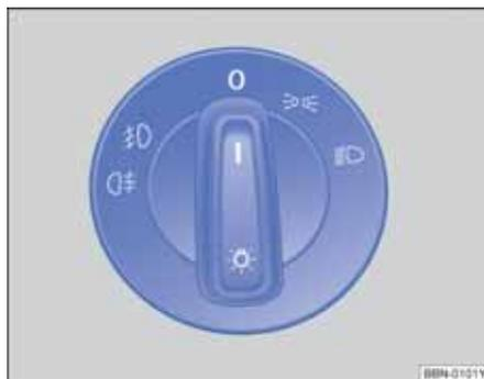
图 70 仪表板局部视图：灯光开关
