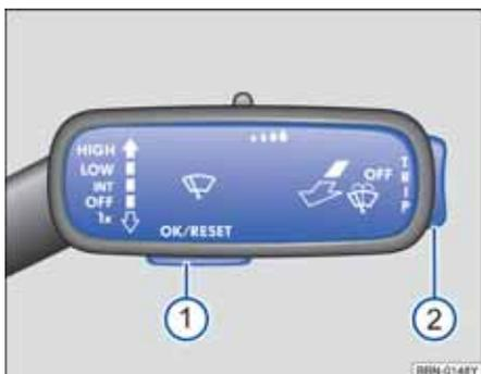
图 15 车窗玻璃刮水器操作杆：按钮①用于操作菜单项，开关②用于切换菜单。
