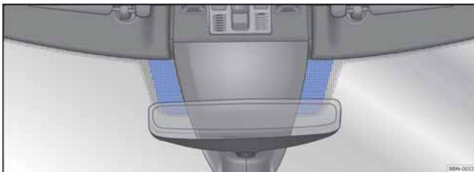
图 73 带通讯窗口（蓝色区域）的红外线反射金属镀层风窗玻璃
