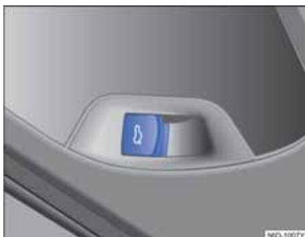
图 30 在驾驶员侧车门内：行李厢盖的开锁按钮。
