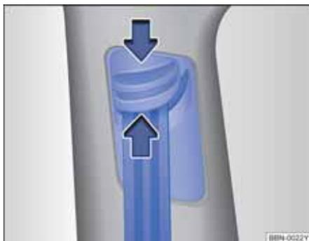
图 59 前座椅旁：安全带高度调整机构。
