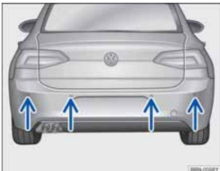
图 114 后部驻车距离探头位置
