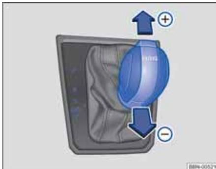
图 109 选档杆在 Tiptronic 手动电控换挡程序位置上。
