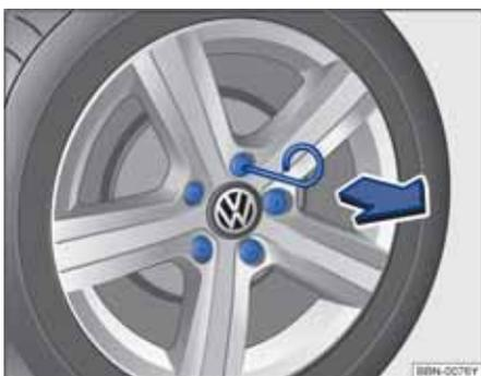
图 205 从车轮螺栓上拔下盖罩
