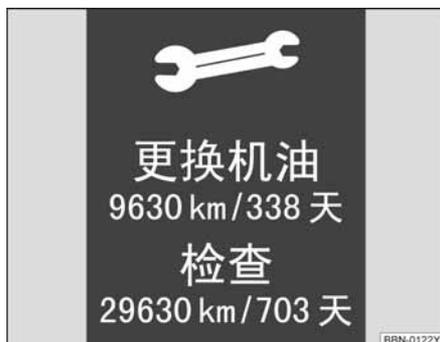
示意图展示了组合仪表上的保养提示。上方有一个扳手图标。中间显示“更换机油 9630 km/338 天”。下方显示“检查 29630 km/703 天”。右下角有代码“BBN-0122Y”。
