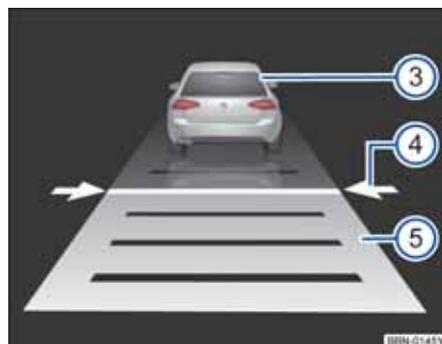
图 146 组合仪表显示屏：自适应巡航系统（ACC）处于激活状态，已探测到前方车辆，正在设定距离间隔
