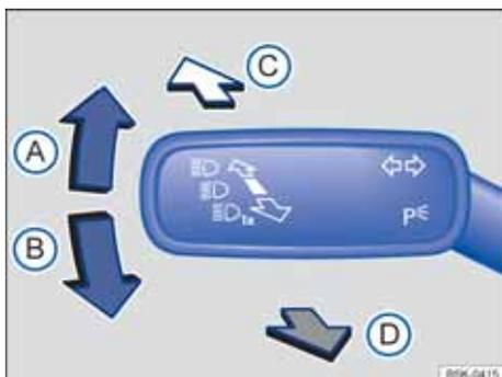
图 68 转向信号灯 / 远光灯操作杆。
