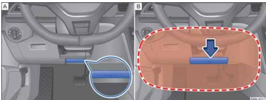
图 64 驾驶员侧：膝部安全气囊安装位置及作用范围
