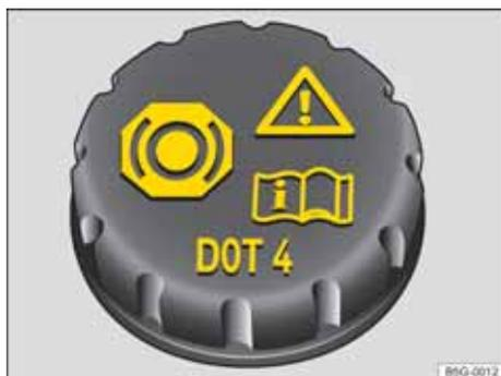
图 111 发动机舱内: 制动液容器的盖子。
