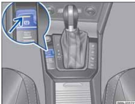
图 110 在中控台下部：电子驻车制动器按钮。
