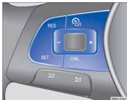
图 142 多功能方向盘左侧：定速巡航系统操作按钮
