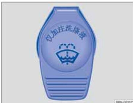
图 78 发动机舱内：车窗清洗液容器盖。
