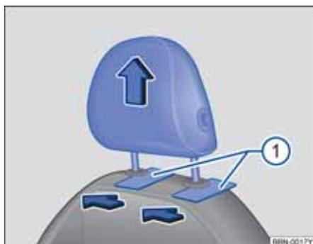
图 43 拆卸和安装前排头枕
