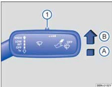
图 76 车窗玻璃刮水器操作杆：调节雨量传感器①。
