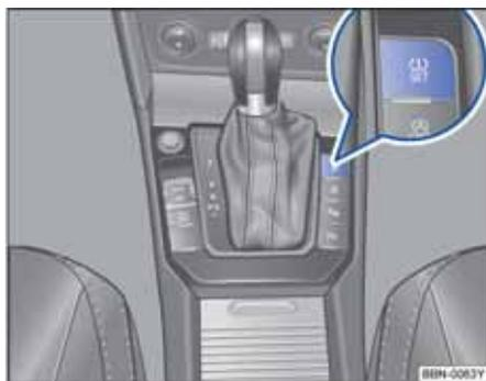
图 165 被动式轮胎气压监控系统设定按钮
