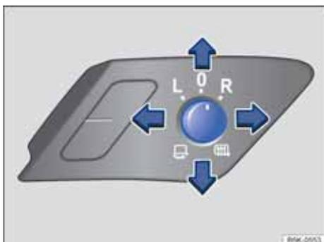
图 81 在驾驶员侧车门内：车外后视镜旋钮。
