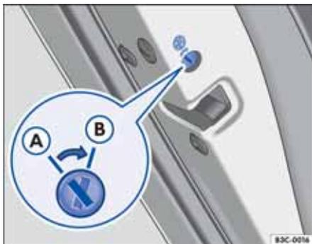
图 28 在左后车门中：儿童安全锁
