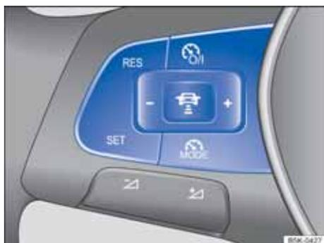
图 148 多功能方向盘左侧：自适应巡航系统 (ACC)
