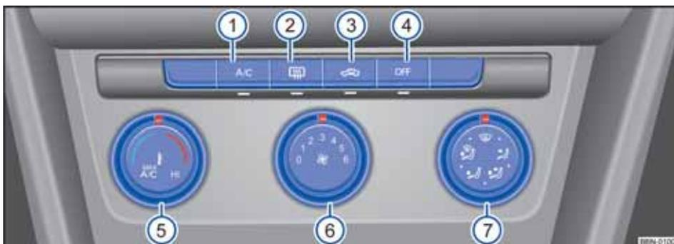
图 166 中控台上：电子手动空调的操作元件
