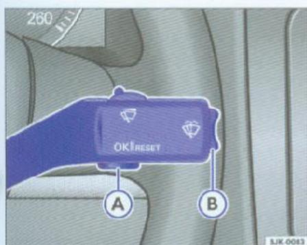
图9 位于风窗刮水器/清洗器上的按钮(A)和跷板开关(B)
