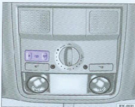
图33 车顶局部图：前部车内灯
