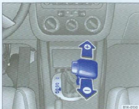
图98 自动变速箱Tiptronic档位板
