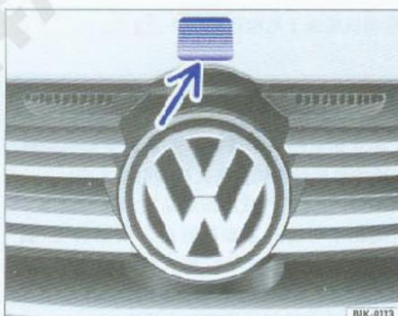
图5 位于散热器隔栅处的发动机舱盖开启拉手
