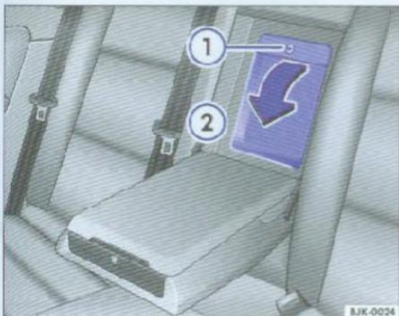
图57 位于后排坐椅靠背上的贯通载物孔
