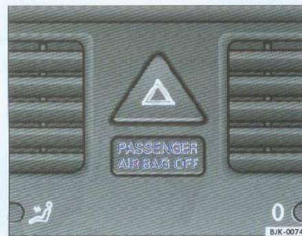
图26 位于仪表板上的安全气囊关闭警报灯
