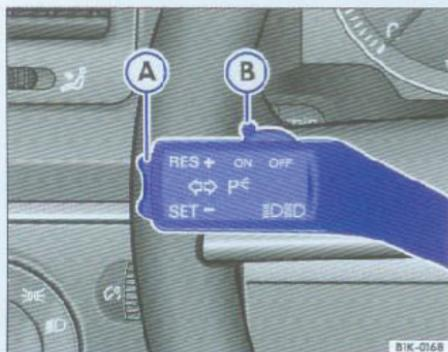
图103 位于转向信号和前大灯远光操纵杆上的车速巡航控制系统开关
