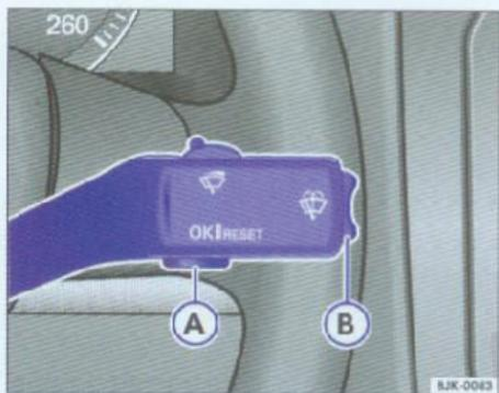
图12 风窗刮水器操纵杆。按钮(A)用于确认菜单项。跷板开关(B)用于切换菜单。
