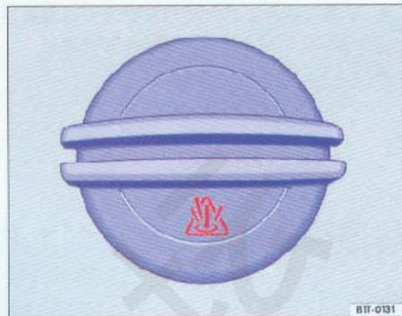
图9 冷却液膨胀罐盖
