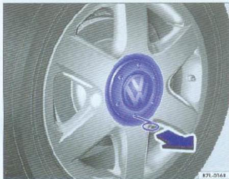
图18 拆卸轮毂罩
