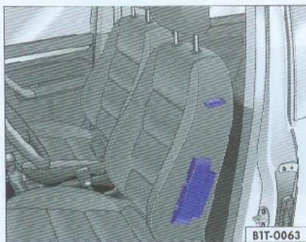
图21 驾驶员座椅侧面安全气囊
