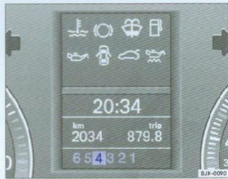
图101 Tiptronic工作模式下的档位显示
