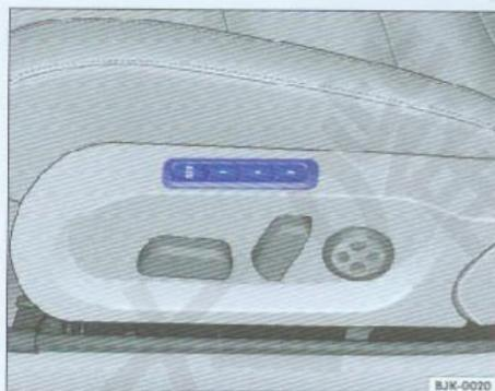
图50 驾驶员座椅上的存储按钮
