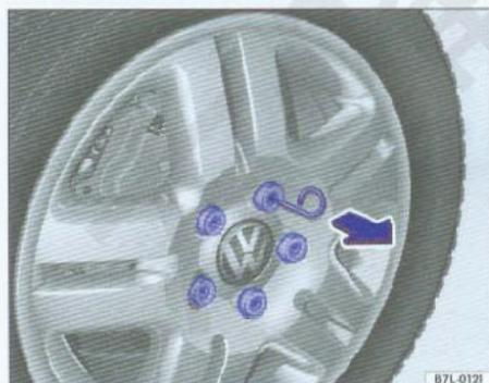
图19 拆卸车轮螺栓防护帽
