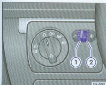
图30 仪表板局部图：仪表及开关照明亮度/前大灯照程调节旋钮
