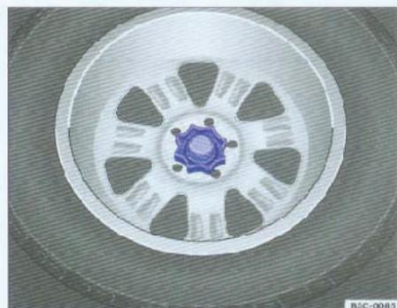
图17 备用车轮用手轮固定在行李箱内
