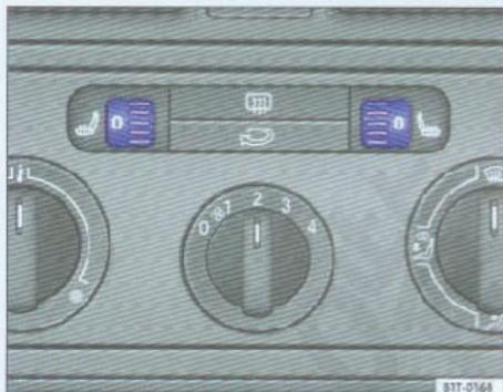
图51 前排座椅加热旋转开关
