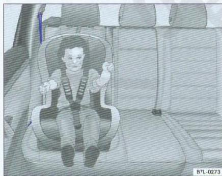
图28 安装在后排座椅上的面朝行驶方向的1级儿童座椅
