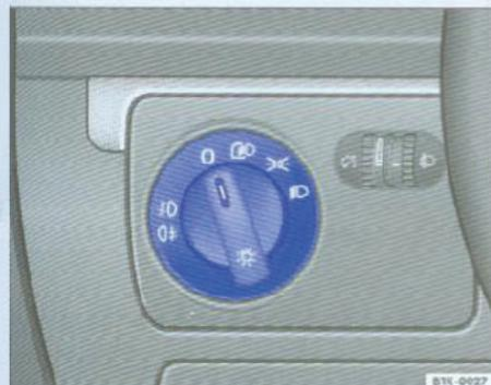
图29 仪表板局部图：车灯、前雾灯及后雾灯开关
