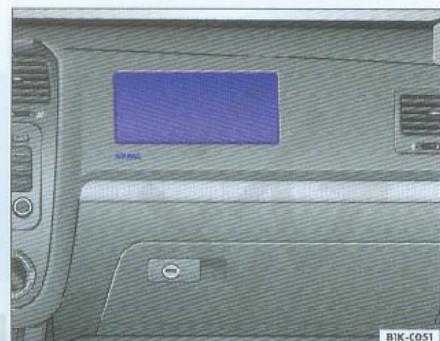
图17 前排正面安全气囊装在仪表板内
