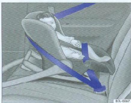
图27 安装在后排座椅上背朝行驶方向的0级儿童座椅
