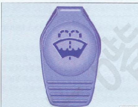
图10 发动机舱内：风窗清洗液储液罐盖
