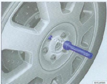
图24 更换车轮：拆卸左轮螺栓
