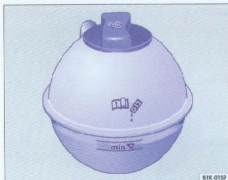
图8 发动机舱内：冷却液膨胀罐
