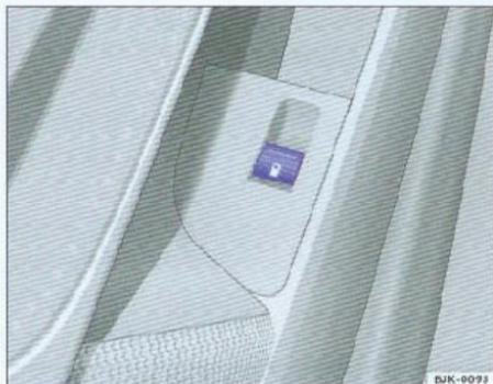
图2 驾驶员侧车门，燃油箱盖板开启按钮
