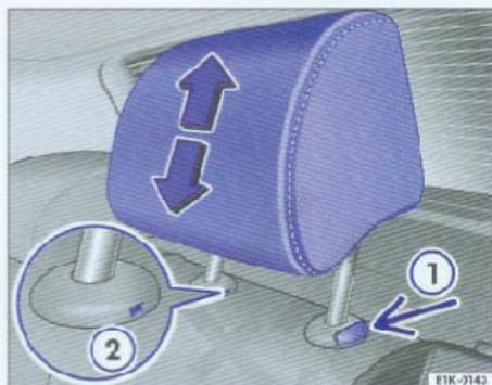
图45 调整和拆卸后排座椅头枕
