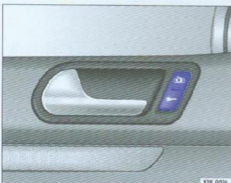
图18 驾驶员侧车门：中央门锁按钮开关
