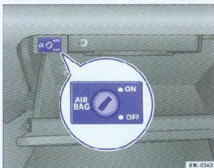
图25 用于关闭和打开前排乘员正面安全气囊的钥匙开关(在杂物箱内)
