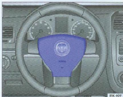
图16 驾驶员正面安全气囊装在方向盘内
