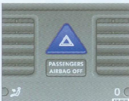
图31 仪表板局部图：危险警报灯开关
