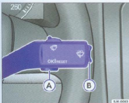
图13 风窗刮水器操纵杆：按钮(A)用于确认菜单项，跷板开关(B)用于切换菜单
