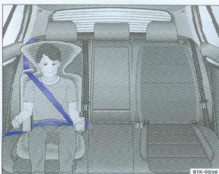
图29 安装在后排座椅上面朝行驶方向的儿童座椅
