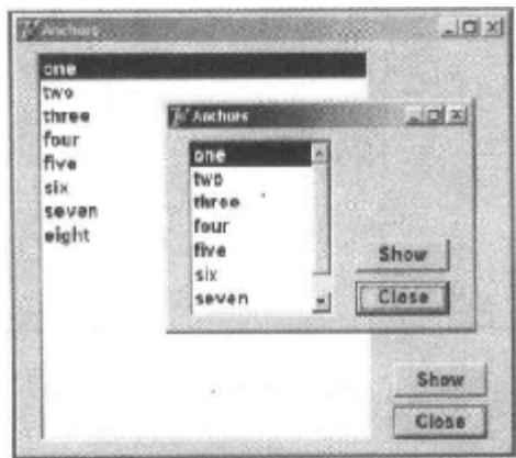
图5.8 在Anchors范例中，当用户改变窗体的大小时，控件会自动移动与改变大小。移动控件不需要编写代码，只需要正确使用Anchors属性即可
