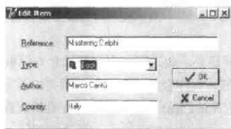
图7.11 使用编辑模式的RefList2范例的对话框。 请注意使用了ComboBoxEx图像组件
