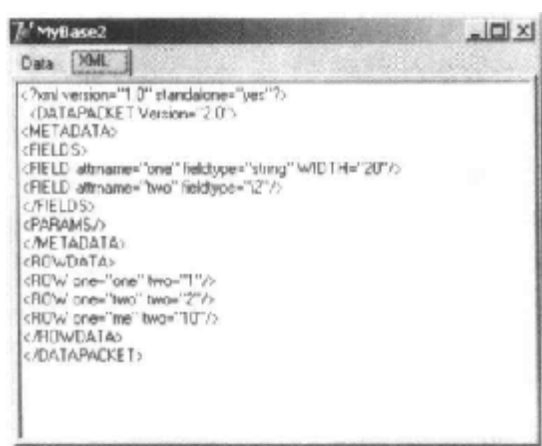
图13.2 用XML格式显示范例MyBase2的CDS文件。表格的结构由程序定义,这个程序在它第一次执行的时候创建了一个文件
