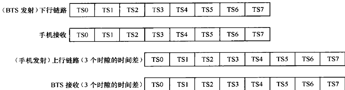
图 3.26 上下行 3 个时隙的偏移
