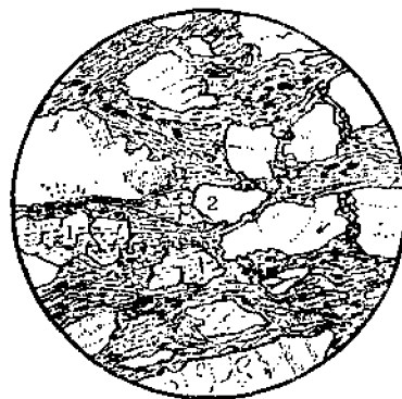
图 Ⅲ—3—7 碎裂结构 （据贺同兴，1980） 长石（1）和石英（2）压碎成眼球状斑晶，细粒部分为石英和绢云母
