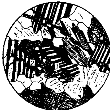
图 Ⅲ—3—6 交代蚕蚀结构 1—斜长石；2—微斜长石，微斜长石交代斜长石，两者界线呈犬牙状，微斜长石中有交代残留的斜长石呈孤岛状
