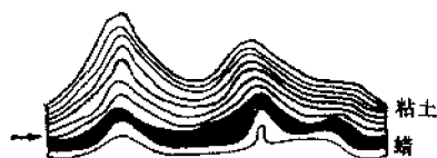
图 IV—2—21 蜡和粘土互层弯曲变形 （引自高等学校《构造地质学》试用教材，1979）
