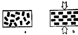
图 I—4—23 岩石在定向压力作用下形成片理的示意图 a—原岩矿物无定向；b—变质后矿物长轴垂直压力方向排列
