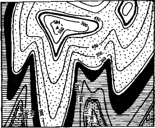
图 IV—1—6 水平岩层的出露和分布特征 （据王素） 上一立体图，下一平面图（地形地质图）
