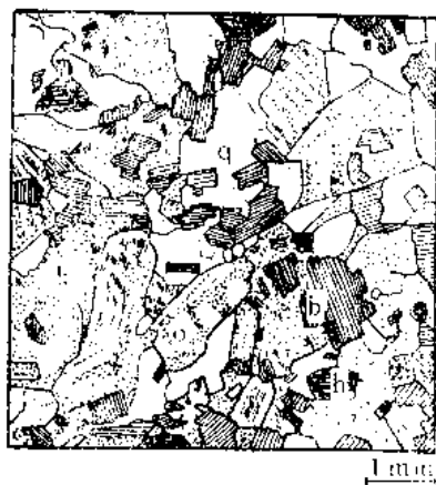
图 1—7 花岗岩的结构 (显微镜下) 黑云母 (b)、角闪石 (h) 和斜长石 (p) 多少保持部分自形，钾长石 (k) 次之，石英 (q) 它形
