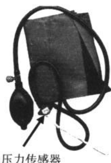
图 8-15 压力传感器与袖带的连接
