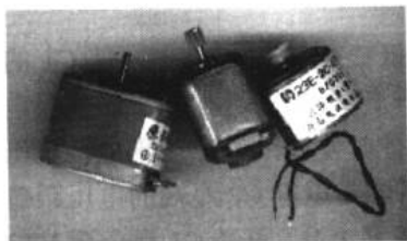
图 6-26 直流低速电机及电路标识
