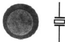
图 2-8 压电陶瓷片的外观和电路标识
