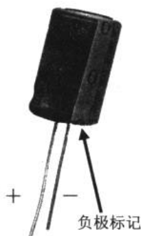
图 1-34 电解电容的极性
