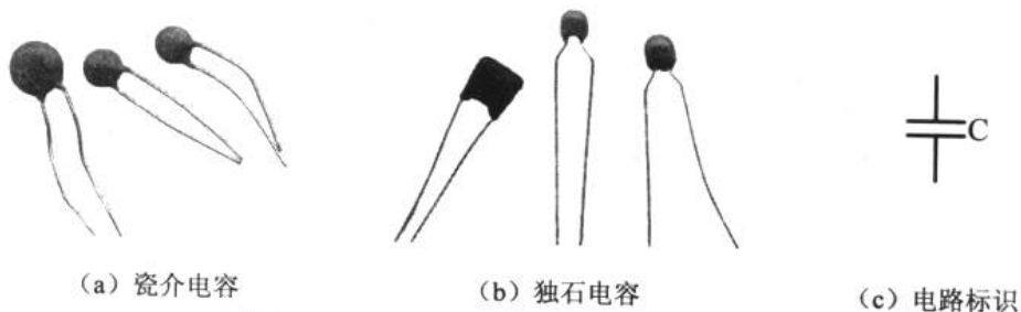
图 1-32 常用无极性电容器及其电路标识
