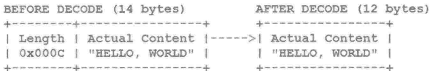
图 4-4 LengthFieldBasedFrameDecoder 工作原理图
