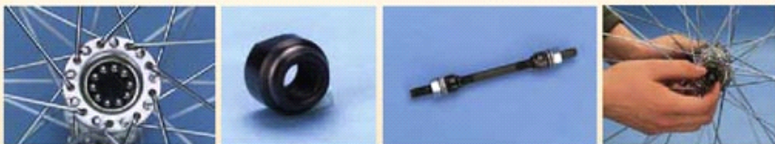
图 3.3-7 安装自行车的滚动轴承
