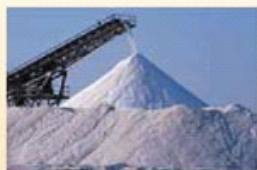
图 3.3-3 传送带靠静摩擦力把货物送到高处
