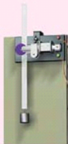
图2.5-1 用打点计时器研究自由落体运动
