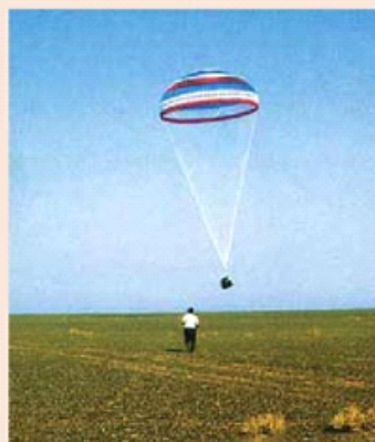
图 3.3-8 神舟号返回舱的空降试验
