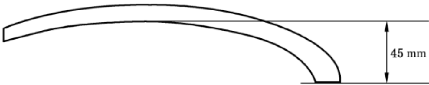
图 C.2 外挡板尺寸测量示例
