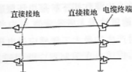
图 4.1.11-2 线路两端直接接地
