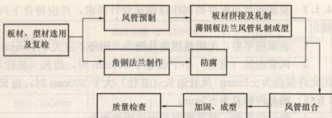
图 4.2.1 金属风管制作工序
