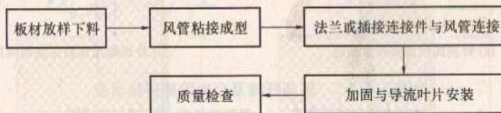
图 5.3.1 玻璃纤维复合风管与配件制作工序
