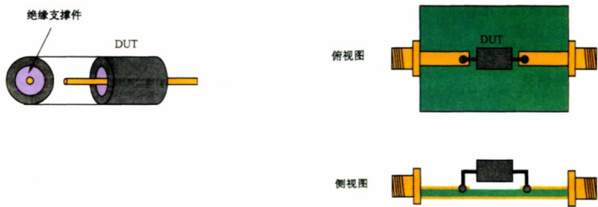
图 23 磁环器件的测试夹具示意图
