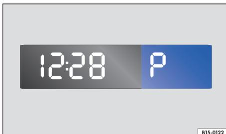
图 13 组合仪表局部图：自动变速箱档位指示器
