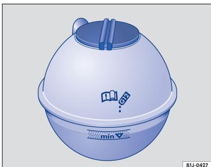
图 107 发动机舱内：冷却液膨胀罐上的液位标记
