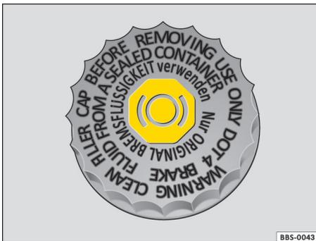
图 88 发动机舱内：制动液储液罐盖
