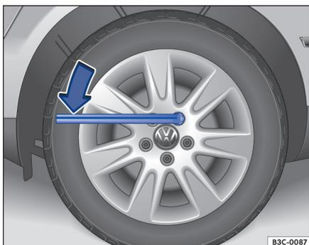
图 127 更换车轮：拧松车轮螺栓
