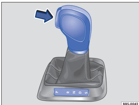
图 86 带锁止按钮（箭头所示）的自动变速箱变速杆
