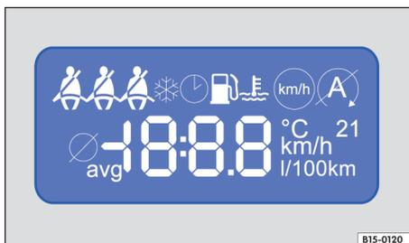
图 11 组合仪表局部图：多功能显示器（MFD）
