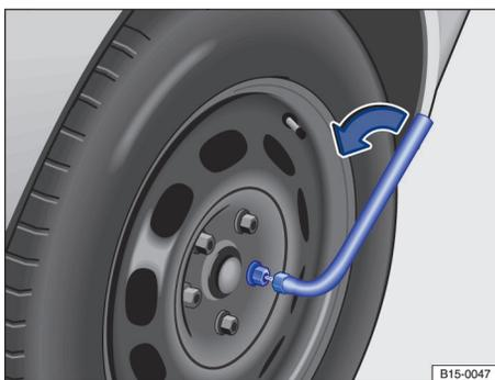
图 130 更换车轮：用车轮螺栓套筒扳手拆卸车轮螺栓
