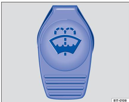
图 65 发动机舱内：风窗清洗液储液罐盖
