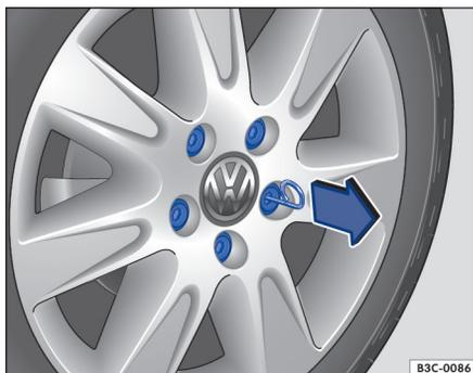
图 126 拆卸车轮螺栓防护帽
