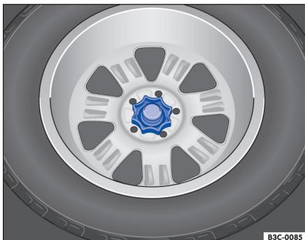
图 113 行李箱内：备用车轮固定手轮
