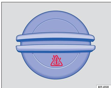
图 108 发动机舱内冷却液膨胀罐盖
