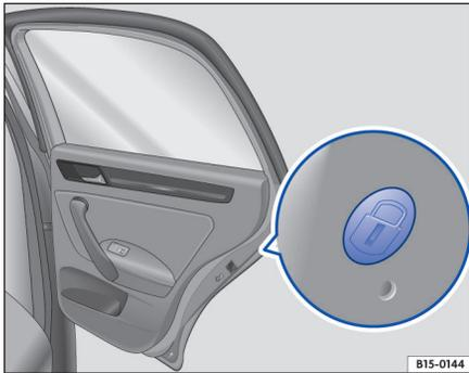
图 121 右后车门端面上：被一橡胶盖遮住的应急车门锁
