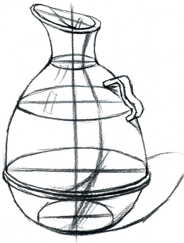
步骤三：进一步将金属水壶的造型画得具体、完整起来，壶口、把手的厚度及透视变化要准确地表现出来。
