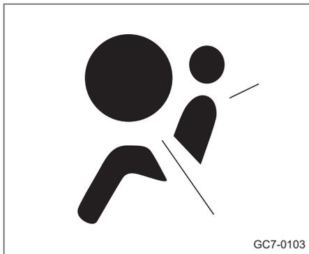
正面安全气囊系统（包括前排预紧式安全带）的工作状态由安全气囊电子控制单元监控，并由安全气囊系统警告灯指示其状态。正常状态下，打开点火开关后，安全气囊系统警告灯将亮大约 6 秒钟，系统完成自检后自动熄灭。
