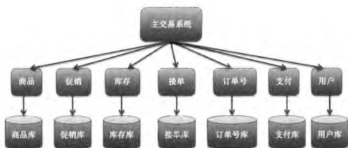
服务拆分后的架构示意图
