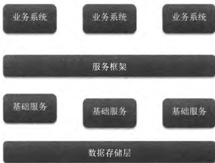
引入服务框架后的架构示意图
