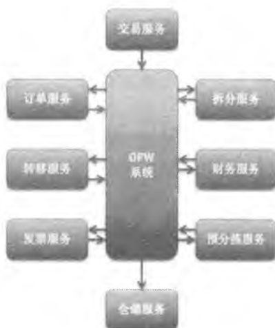
引入事件驱动后的生产系统架构示意图
