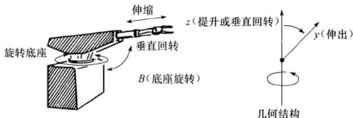
图 1-5 球面坐标机器人
