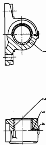
1—轴承座；2—整体轴承；3—油孔；4—螺栓孔 图 12-1 整体式径向滑动轴承
