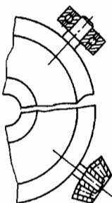
图 11-12 滚子齿蜗轮(示意图)
