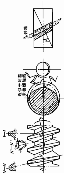
图 11-7 锥面包络圆柱蜗杆(ZK 蜗杆) (a) 近似于阿基米德螺旋线 (b) 砂轮
