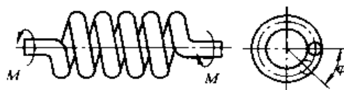
图 18-19 扭转弹簧的载荷
