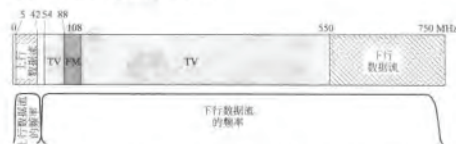
图 2.48 在一个典型的用于 Internet 访问的有线电视系统中频率的分配情况
