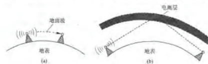
图 2.12 (a) 在 VLF、LF 和 MF 波段,无线电波沿着地面传播; (b) 在 HF 波段,无线电波被电离层折射回来
