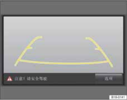
图 131 可视摄像头显示。显示画面及选项功能视车型而定：某些车型的可视摄像头与前后驻车距离报警的图像不在同一画面中显示；某些则因不具备选项功能，故画面中无选项按钮或按钮呈灰色
