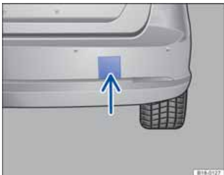
图 183 在保险杠右后部：拆卸盖板
