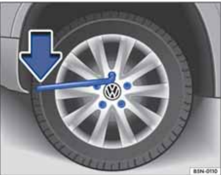
图 176 更换车轮：松开车轮螺栓
