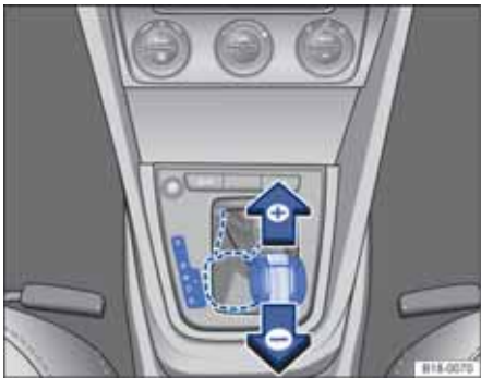
图 123 选档杆在 Tiptronic 手动电控换挡程序位置上
