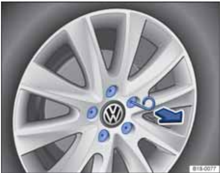
图 175 从车轮螺栓上拔下盖罩
