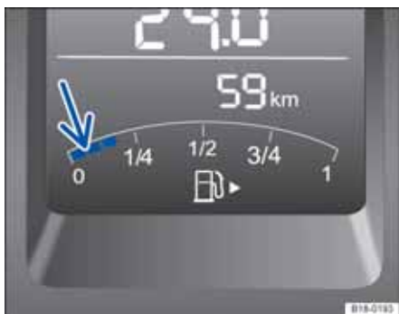
图 147 组合仪表局部视图：燃油存量表
