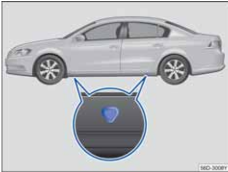
图 177 用于汽车千斤顶的支撑点
