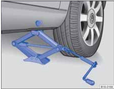
图 178 将千斤顶放在汽车左后侧
