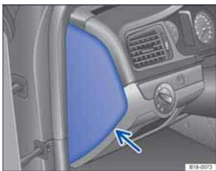
图 179 仪表板的左侧：保险丝盒的盖板
