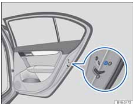
图 167 左侧后车门端面处的应急上锁装置（由橡胶密封件遮盖着）
