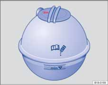
图 155 冷却液补偿容器上的液位标记
