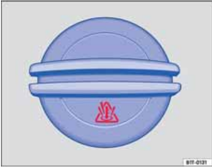
图 156 冷却液补偿容器盖
