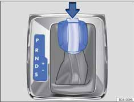
图 121 带锁止按钮（箭头所示）的自动变速箱选档杆
