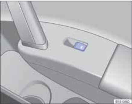
图 45 在前排乘员和后排车门内：车窗升降器的按钮
