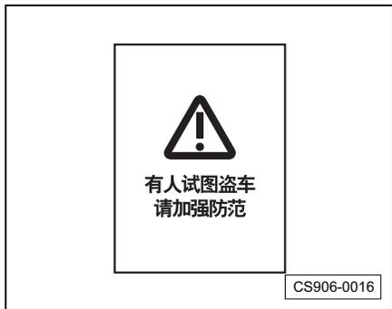
如用无效车辆钥匙启动本车发动机，则组合仪表液晶显示屏显示相应的防盗信息，此时无法启动发动机。
