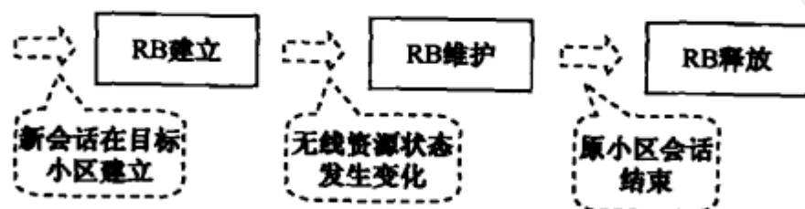
图 10-18 RB 的建立、维护和释放
