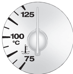
发动机冷却液温度表
