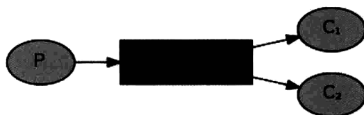
图3-2 RabbitMQ一个生产者轮询多个消费者的示意图
