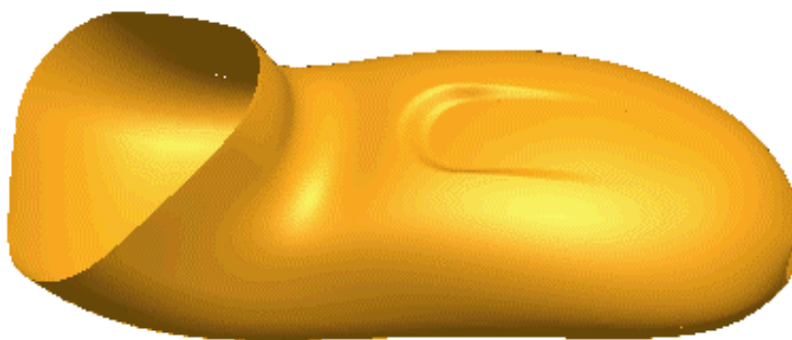
图 2：安置电源开关的最终凹窝造型
