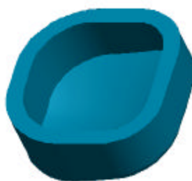
图 6：使用偏移添加的侧曲面
