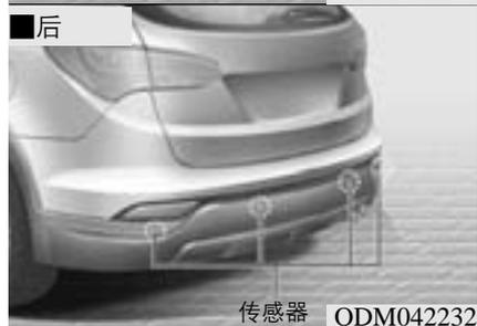
在车辆移动过程中,驻车辅助系统向驾驶员提供帮助。如果检测到在车辆前方100cm(39.4in.)和车辆后方120cm(47in.)的距离内有物体存在,该系统会发出警告音。
