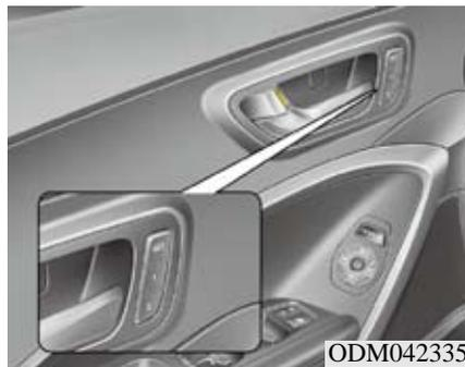
在车辆上提供了驾驶席位置记忆系统, 借助一个简单的按钮操作存储和恢复驾驶席座椅位置和室外后视镜位置。通过存储理想位置到系统记忆装置中, 2名驾驶员可根据他们的驾驶习惯设置并存储驾驶席座椅和后视镜的位置。如果分离了蓄电池, 位置记忆数据会被删除, 此时应重新设置驾驶席位置。
