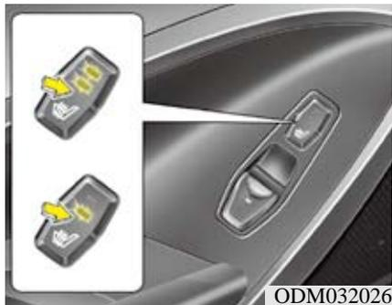
座椅加热器在寒冷季节加热后座椅。
