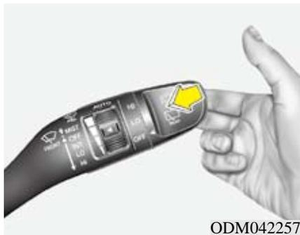
在OFF位置，朝您的方向轻拉雨刮器开关杆，向挡风玻璃喷射清洗液并运转雨刮器1~3周期。
