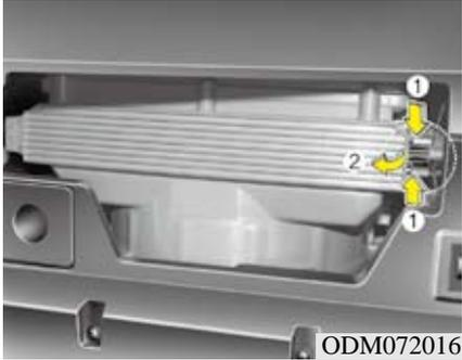
3. 在按下盖右侧的锁片状态, 拆卸空调空气滤清器壳。
