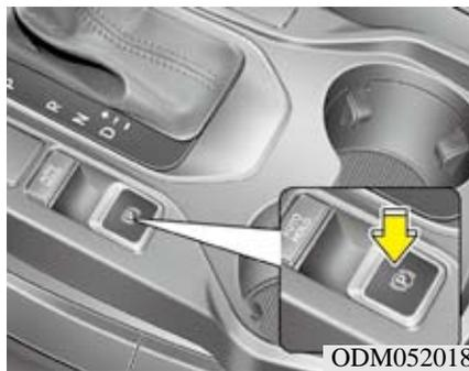
要释放电控驻车制动器(EPB)，在下列状态下按下EPB开关：
