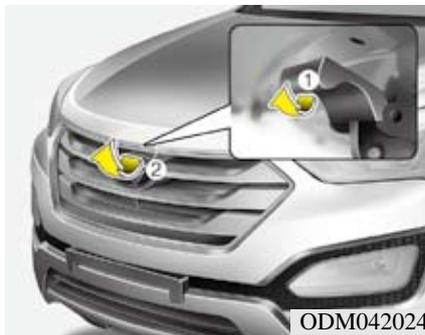
2. 来到车辆前方，稍微举升发动机罩，上推发动机罩中央内侧的第二挂钩(1)并举起发动机罩(2)。
