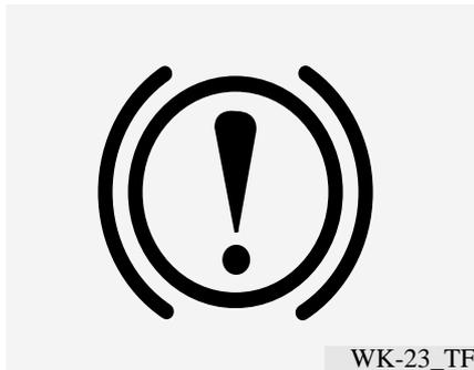
把点火开关转至ON位置(不起动发动机), 检查驻车制动警告灯。在点火开关置于ON或START位置状态设置驻车制动器时, 此警告灯亮。
