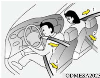
您车辆配备了驾驶席和助手席安全带拉紧器(卷带器拉紧器和应急拉紧器(EFD))。当发生正面碰撞事故,其严重性达到一定程度时安全带拉紧器与空气囊一起启动。如果车辆突然停车或乘员快速前倾,安全带卷带器会锁定。在一定程度正面碰撞中,拉紧器启动并拉动安全带紧固乘员的身体。
