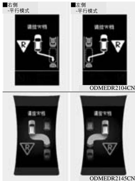
驾驶前进搜索停车位期间，如果搜索结束，显示上述信息并且发出一次蜂鸣声。停车并将变速杆挂到R(倒档)位置。
