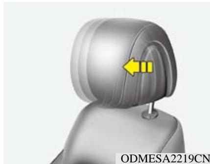
向前拉头枕到理想止动位置可向前调整头枕到4个不同位置。要向后调整头枕到最后位置，向前拉头枕到最前位置后释放。调整头枕使其正确支撑乘员的头部和颈部。
