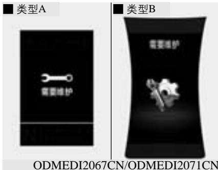
如果没有根据已输入维护保养间隔周期维护保养车辆, 每次将点火开关或发动机起动/停止按钮置于ON位置(里程和日期变为"---")时显示"需要维护"信息几秒钟。
