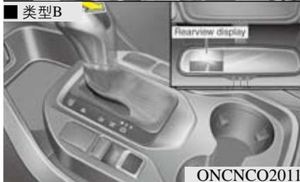
点火开关置于ON位置、变速杆置于R(倒档)位置状态倒车灯亮时,后视摄像头启动。
