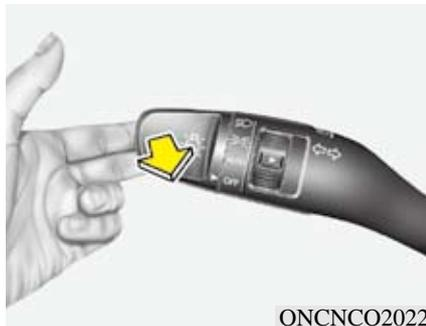
朝您所在的方向拉灯光开关杆。释放时灯光开关杆可返回到正常位置。使用闪光功能时不需要接通大灯开关。
