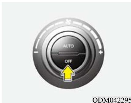
按下前鼓风机OFF按钮即可关闭前空调控制系统。只要点火开关在“ON”位置，仍能操纵通风模式和内外气选择控制按钮。
