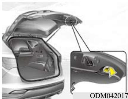
放低并牢固按压后备箱门。确定后备箱门牢固锁住。
