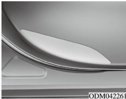
打开车门时车门礼貌灯亮，方便进出车辆。也用它警告来往车辆该车辆的车门处于打开状态。
