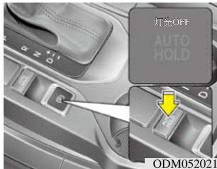
要解除自动固定操作, 请按下自动固定开关按钮。自动固定指示灯熄灭。
