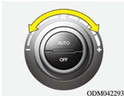
您可以使用鼓风机速度控制旋钮控制车内气流的鼓风速度。
