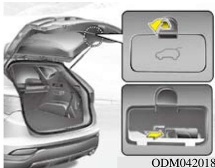
在您车辆的后备箱门底部配备了紧急后备箱门安全释放杆。有人不慎被锁在后备箱内时,可通过下列操作打开后备箱门。
