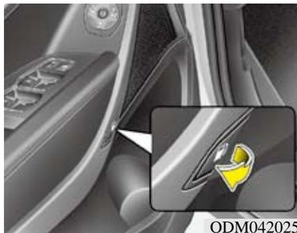
必须通过拉起驾驶席车门上的燃油加油口门开启杆从车内打开燃油加油口门。
