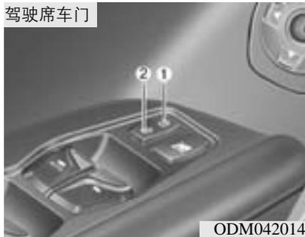
通过按动中央控制门锁操纵开关可操作中央控制门锁。
