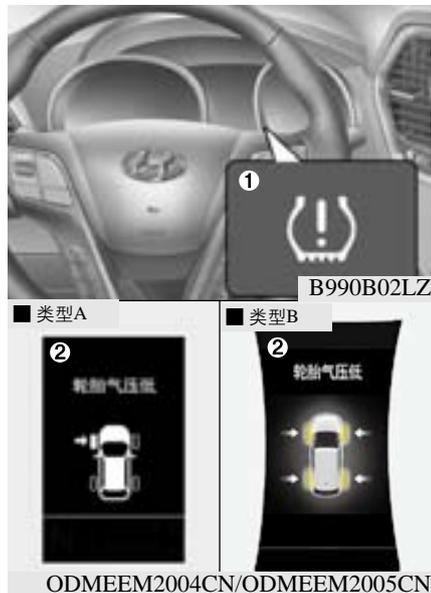
在轮胎冷态, 应每个月对包括备胎(如有提供)在内的每个轮胎检查一次充气压力, 并根据车辆标牌或轮胎充气压力标签上的车辆制造商推荐的充气压力标准给轮胎充气。(如果您车辆的轮胎中有与车辆标牌或轮胎充气压力标签上指定轮胎尺寸不同的轮胎, 您应确定这些轮胎的正常轮胎充气压力。)
