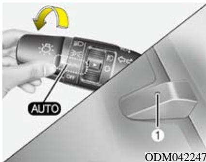
自适应大灯系统利用转向角度和车速信息，通过大灯左右和上下偏转调整大灯垂直和水平方向来保持宽广的视野。在发动机运转状态，大灯开关置于AUTO位置时，大灯ON的同时自适应大灯系统启动。要关闭AFLS，将灯光开关转至其它位置。AFLS系统OFF后，大灯垂直方向转动调整功能不工作，但大灯水平调整功能仍工作。
