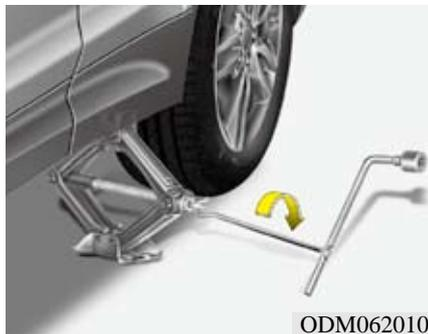
8. 把千斤顶手柄插入千斤顶并顺时针旋转，举升车辆直到轮胎刚好离地。这个测量值约为30 mm(1.2in)。在拧下轮毂螺母前，确认车辆静止，并且没有滑动或移动的危险。
