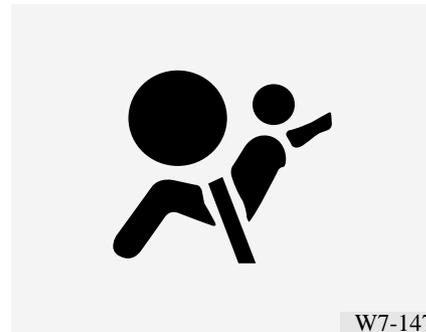
仪表板上的气囊警告灯用于警告您气囊-辅助保护系统(SRS)可能有故障。
