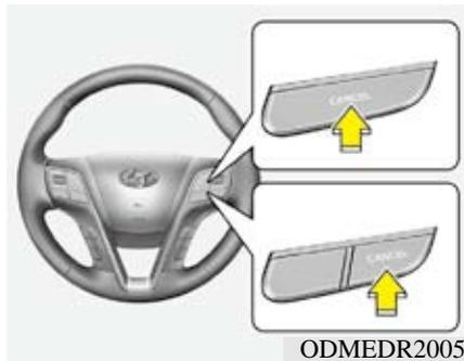
以上各项操作中的任意一项都可解除巡航控制操作(仪表盘上的SET指示灯熄灭)，但系统不会关闭。如果您要恢复巡航控制操作，向上移动方向盘上的远程控制开关(到RES+)，就会恢复到以前设定的巡航速度。
