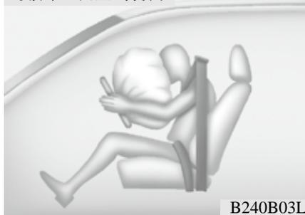
完全展开的空气囊结合正确佩戴的安全带能减缓驾驶员或乘员的前冲运动,降低头部和胸部的受伤机率。
