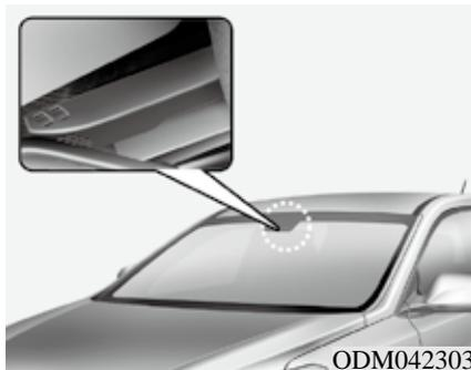
自动除湿系统通过自动检测挡风玻璃内侧的湿气降低挡风玻璃内侧的生雾可能性。自动除湿系统在空调控制系统接通时工作。
