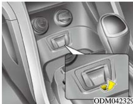
如果您的车辆配备了Aux和/或USB(通用串行总线)接口, 可使用Aux接口连接音响设备, 使用USB接口连接USB和iPod。
