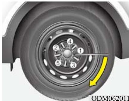
然后按图示放置扳手并拧紧车轮螺母。确定套筒完全套在螺母上，禁止站在扳手手柄上或在扳手手柄上使用延长管。顺着车轮紧固每个螺母，直到它们全部被拧紧为止，再次检查每个螺母的紧固情况。车轮换位后，请北京现代授权经销商检查系统。
