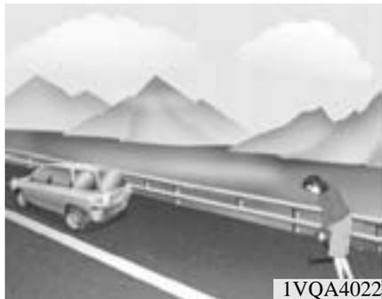
1. 把车辆停在平坦地面上, 牢固设置驻车制动器。
