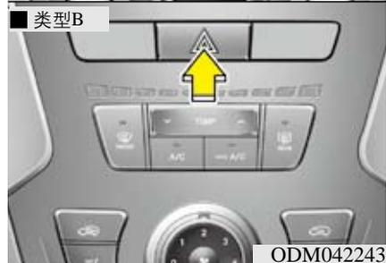
按下危险警告灯开关可接通危险警告灯，所有转向信号灯闪烁。即使点火开关钥匙不在点火开关内，危险警告灯也工作。再按一次危险警告灯开关，即可关闭危险警告灯。
