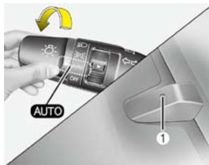
灯光开关在“**AUTO**”灯位置时, 尾灯及大灯将根据室外光线的亮度自动亮灭。如果车辆配备自适应大灯系统(AFLS), 该系统在大灯ON时也工作。
