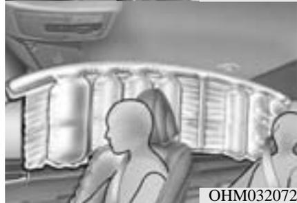
\*实际车辆内的空气囊配置可能与图示不同。
