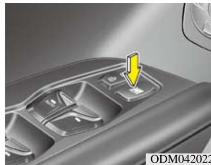
驾驶员可以通过把驾驶席车门上的电动门窗锁止按钮按到“LOCK(锁止)”位置(按下)来停用后乘员车门上的电动门窗开关。
