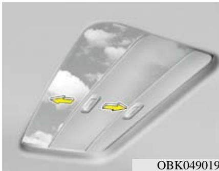
玻璃板滑动时遮阳板会自动随玻璃板打开。如果要关闭遮阳板，可以手动关闭。
