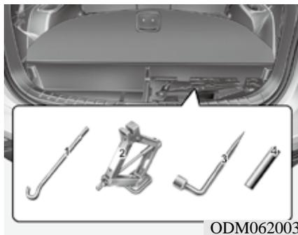
千斤顶、千斤顶手柄和车轮螺母扳手储存在行李舱内。
