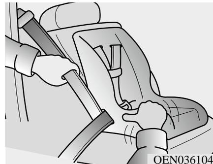
3. 扣上安全带扣环并收回安全带松弛部分。安装儿童保护系统后，试探性地朝各个方向移动儿童保护系统，确定儿童保护系统安装牢固。
