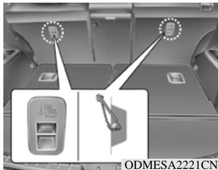
儿童保护系统挂钩固定锚位于后座椅靠背的后面。
