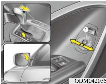
将变速杆挂入R(倒车)位置时，室外后视镜向下偏转帮助倒车行驶。根据室外后视镜选择开关(1)的位置，室外后视镜操作如下：
