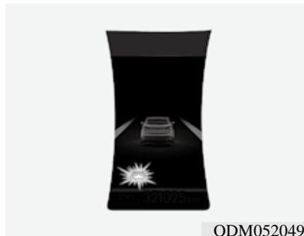
要使LDWS进入启动模式, 在发动机启动/停止按钮位于O N位置时按下按钮, 仪表盘上的指示灯亮。再次按下按钮可解除LDWS控制。
