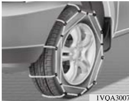
由于子午线轮胎侧围较薄，如果在其上装配某些类型的防滑链，可能会损坏轮胎。因此使用推荐的防滑轮胎代替防滑链。不要在配备铝制车轮的车辆上安装轮胎防滑链，因为防滑链会损坏这种车轮。如果必须安装防滑链，请使用厚度不超过12mm(0.47in)的钢丝型防滑链。由于防滑链使用不当而导致的车辆损坏不在车辆制造商的保修范围内。
