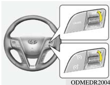
如果使用
