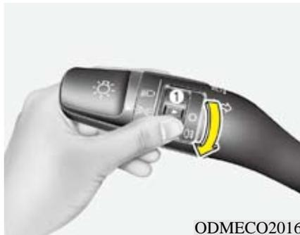
要点亮后雾灯，在大灯开关ON状态将后雾灯开关(1)置于ON位置。
