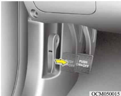
检查用30kg(66lb, 294N)的力踩下驻车制动踏板时行程是否在规定范围内。应仅用驻车制动器就能把车辆固定在相当陡的斜坡上。如果驻车制动器行程大于或小于规定值, 请北京现代授权经销商检修系统。
