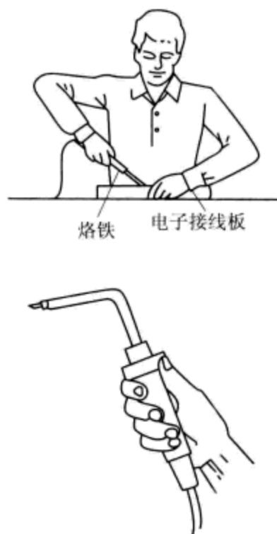
图 7-32 烙铁把手的设计
