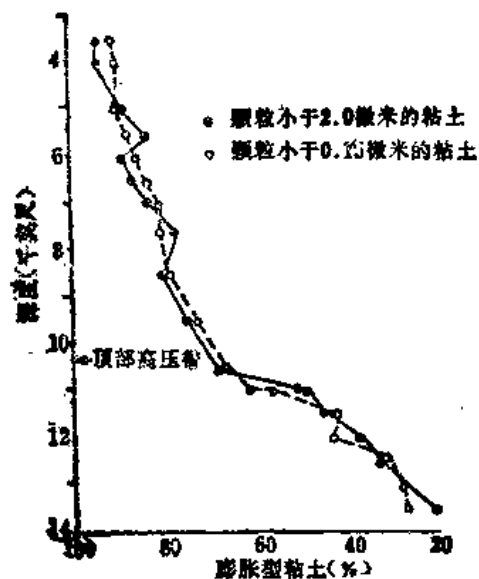
图 4-16 膨胀型粘土(蒙脱石)向非膨胀型粘土(伊利石)转化的数量随深度增加的曲线(据Schmidt, 1978)
